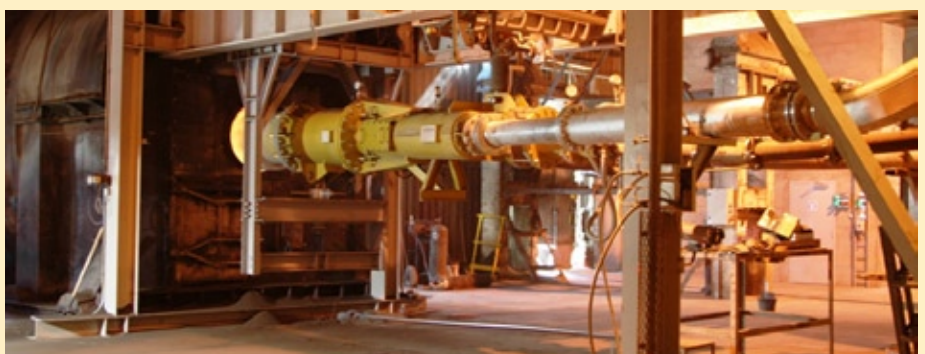
Mitmekanaline põleti "Unitherm" vedelate ja tahkete alternatiivkütuste põletamiseks
