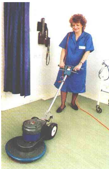
Pilt 25. Tõsine viga: elektrijuhe on töötajal üle õla. Vältida kehalist kontakti elektrijuhtmetega.
