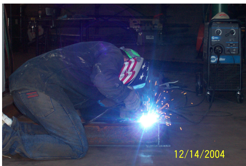
Pilt 4. Keevitusel tekkiv kiirgus, mis ilma näokaitsevahendita töötamisel kahjustab silmade limaskestasid
