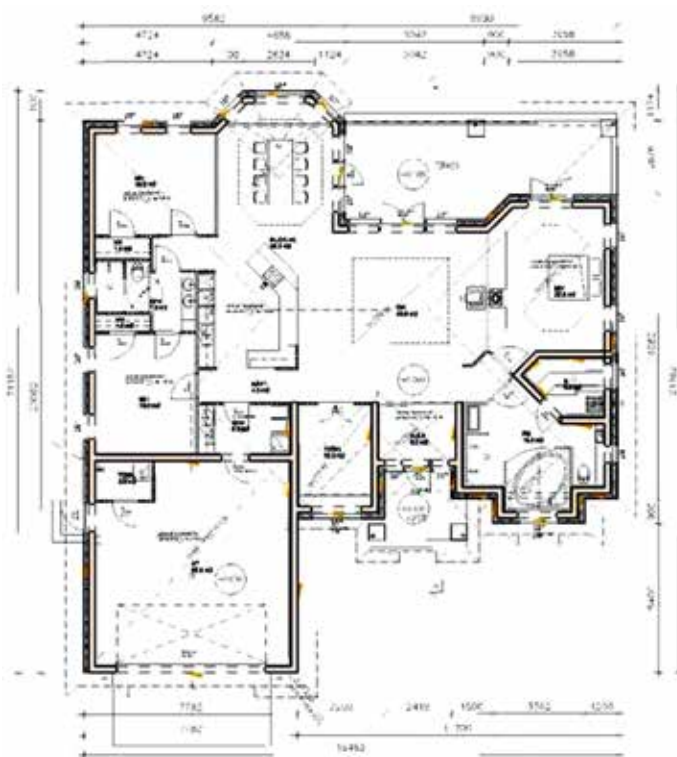
Joonis 3. Mõõtmetega põhiplaan. Tänapäevaste CAD-programmidega saab ka PDF-faili vajalikku mõõtkava seadistada. Meinrad Rohneri joonis.
