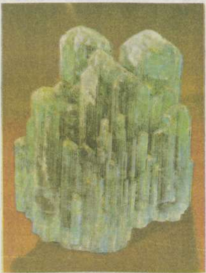
Keeruka keemilise koostisega turmaaliin NaMg_6[B_3Al_3Si_6O_{25}(OH)_3] esineb looduses tavaliselt veidi sfäärilise ristlõikega kolmetahulise samba kujuliste kristallidena. Termo- ja piesoelektriliste omaduste tõttu kasutatakse seda raadiotehnikas, kuid ühtlasi on ta ka hinnatud poolväärikivi. Pildil olev pala on pärit Brasiiliast. Eestis võib ilusaid turmaaliinikristalle leida rändkividest.
