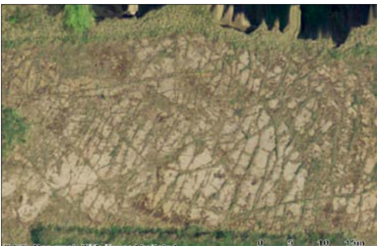
Foto 2. Paelasundit läbiv korrapärratu lõhede võrgustik Sõtke rikke piirkonnas.
