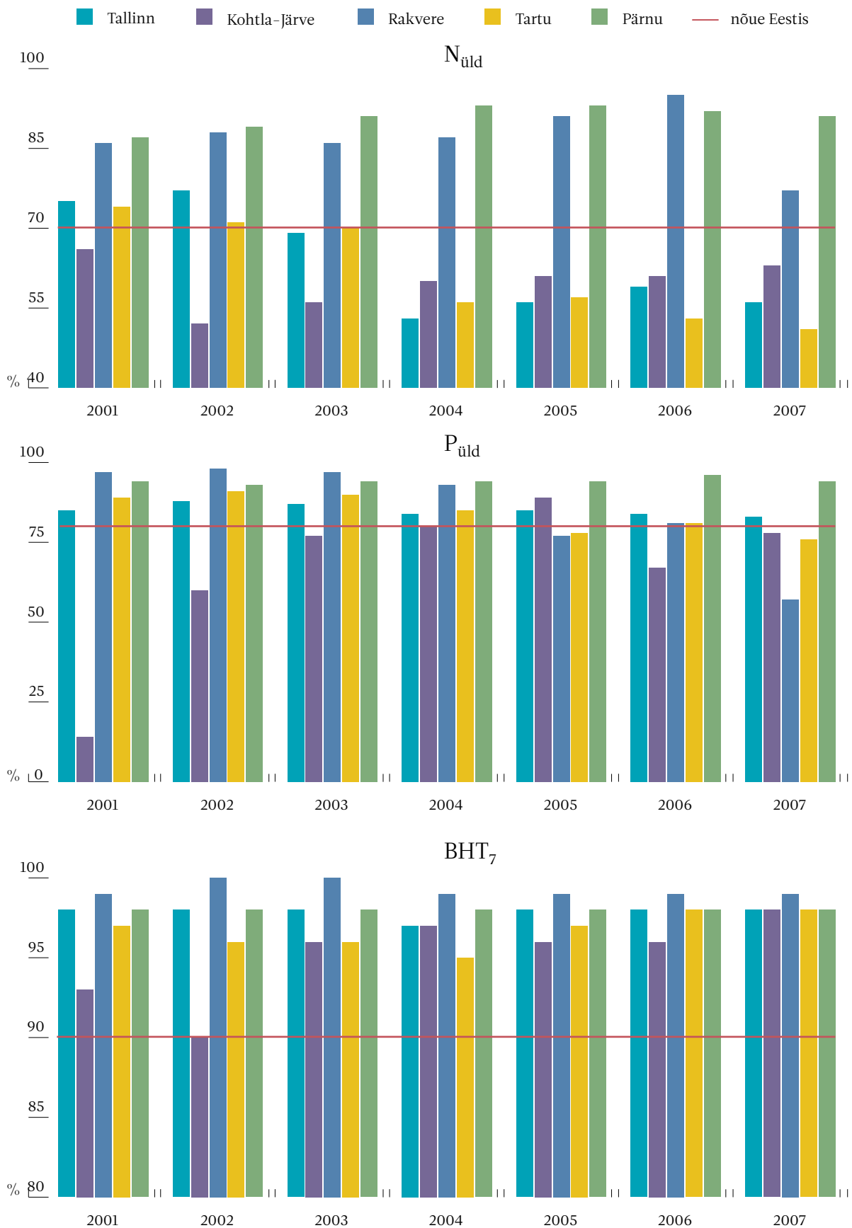
Joonis 6.10. Üle 100 000 ie-ga reoveepuhastusjaamade puhastustõhusus biokeemilise hapnikutarbe ( BHT_7 ), fosfori ( P_{\text{üld}} ) ja lämmastiku ( N_{\text{üld}} ) järgi aastail 2001–2007. Andmed: ITK.
