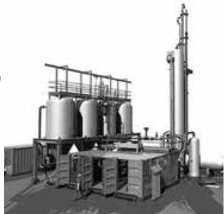
Joonis 4. Keemilise puhastuse seade (nn amiinopesu). Tootlikkuse vahemik 250–2500 Nm 3 /h.
