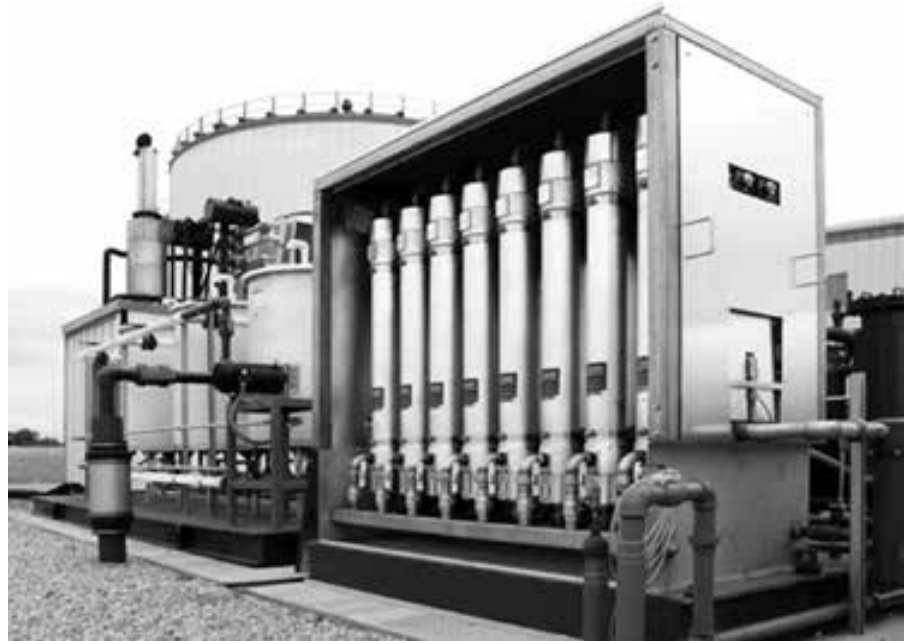
Joonis 5. Membraanpuhastusseade. Tootlikkus 100–1000 Nm 3 /h.
