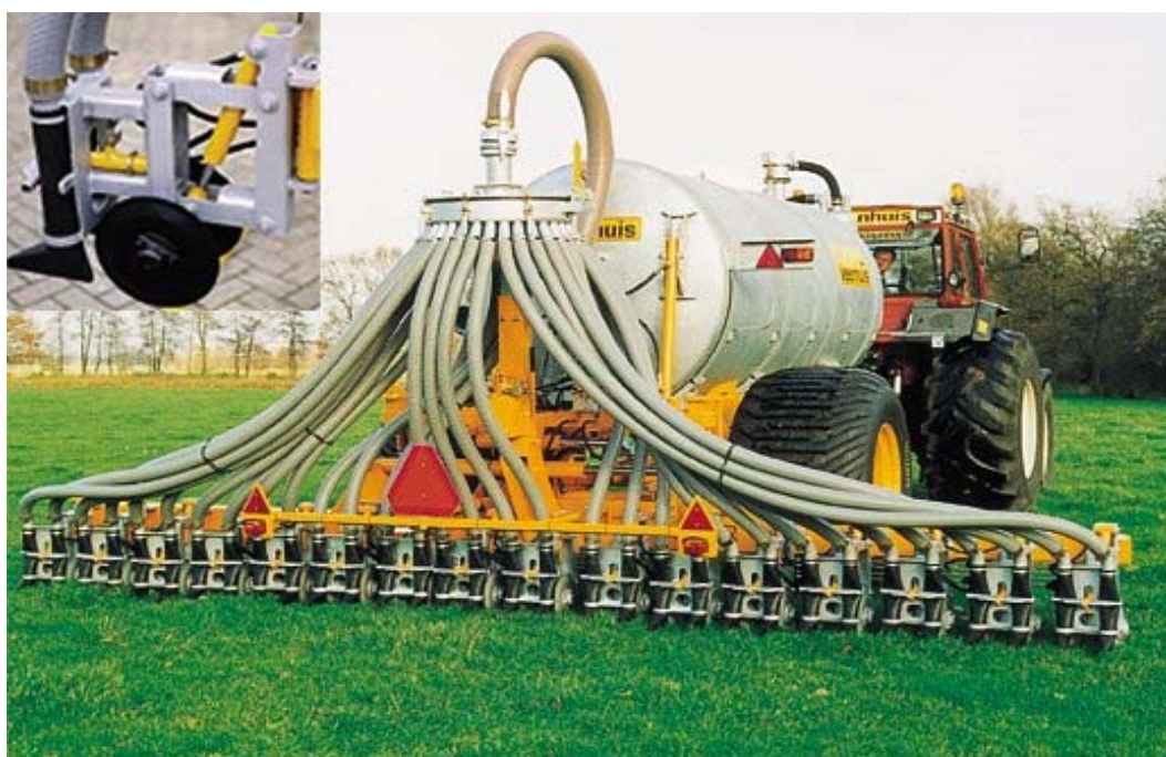
Joon. 10. Tihendusrataste ja sahkäppadega vedelväetusmasin; rohkamaral on väetise sisestamise sügavus 1...3 cm, küntud põllul 2...5 cm [7, 8].
