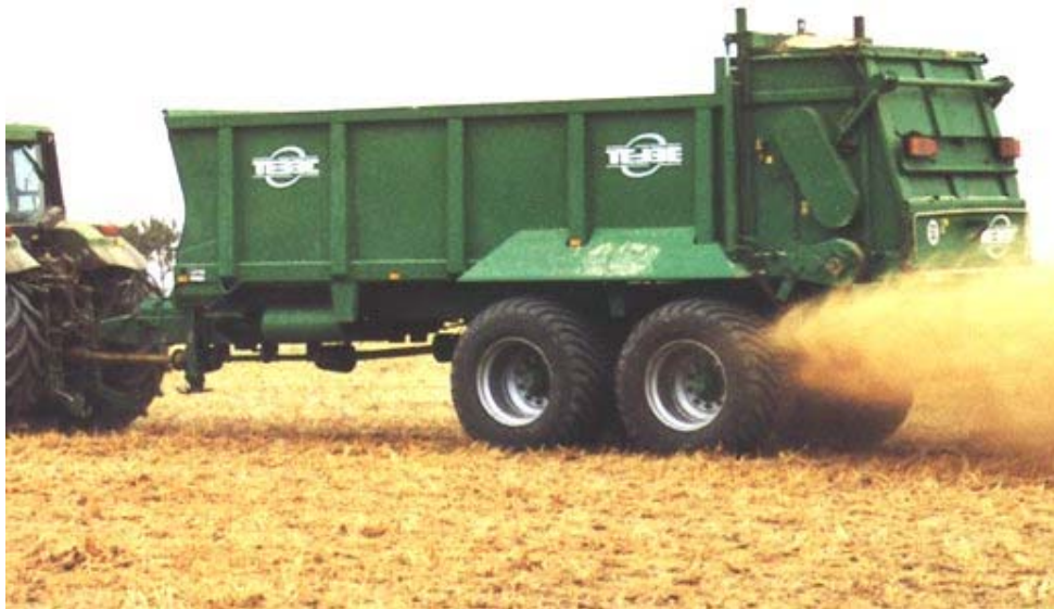
Joon. 14. Sõnnikulaotur, mille laotusseadis koosneb kahest rõhtsast tseentrifugaalkettast ja kahest rõhtrullist (-biitrist) [7].
