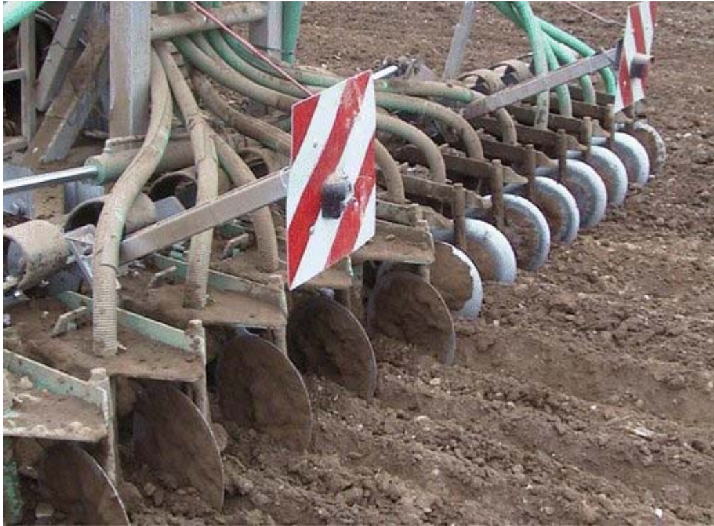
Joon. 8. Sfäärketaskäppadega vedelväetusmasin (vt. ka joon. 6, b); väetise mulda sisestamise sügavus rohkamaral (karjamaa) on kuni 2 cm, põllul töötamisel aga kuni 10 cm [8].
