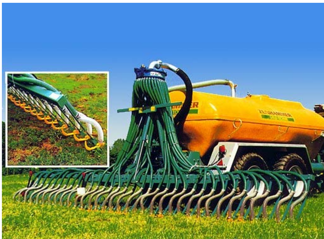
Joon. 5. Vedelsõnniku jaotamine karjamaal (liuguva taldmikuga süsteem, tüüp e, joonis 6, sisestamise sügavus kuni 2 cm) [7].
