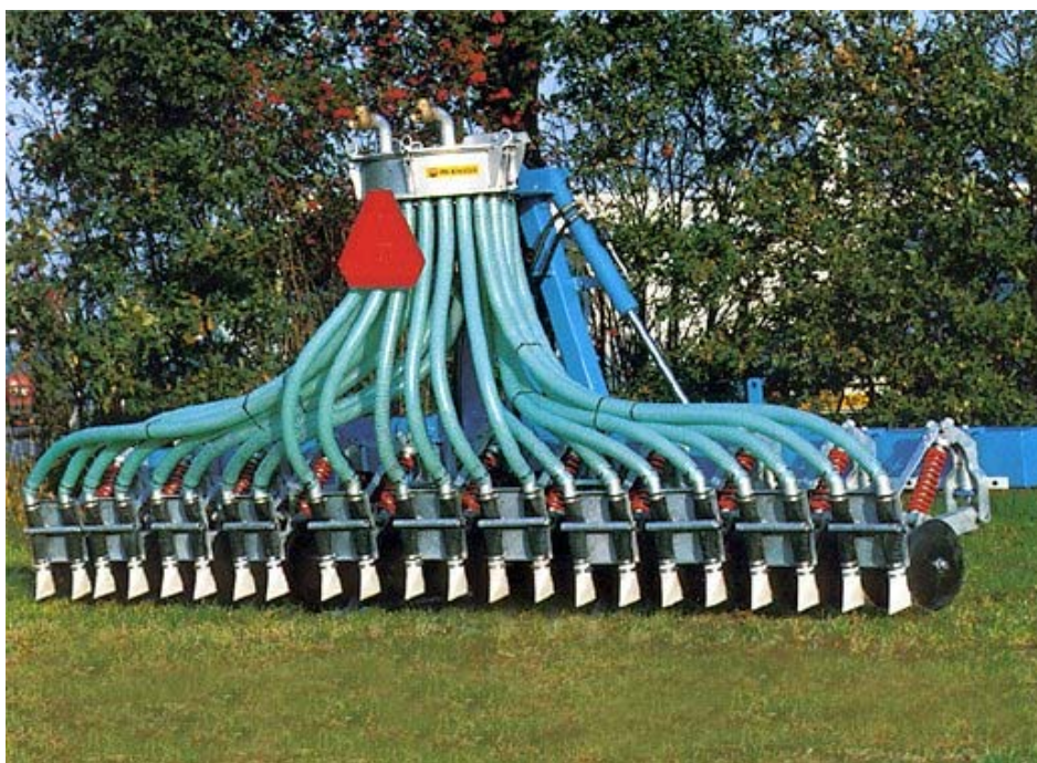
Joon. 7. Kahekettalise ketaskäpaga vedelvätusmasin (vt ka joon. 6, a) [8].
