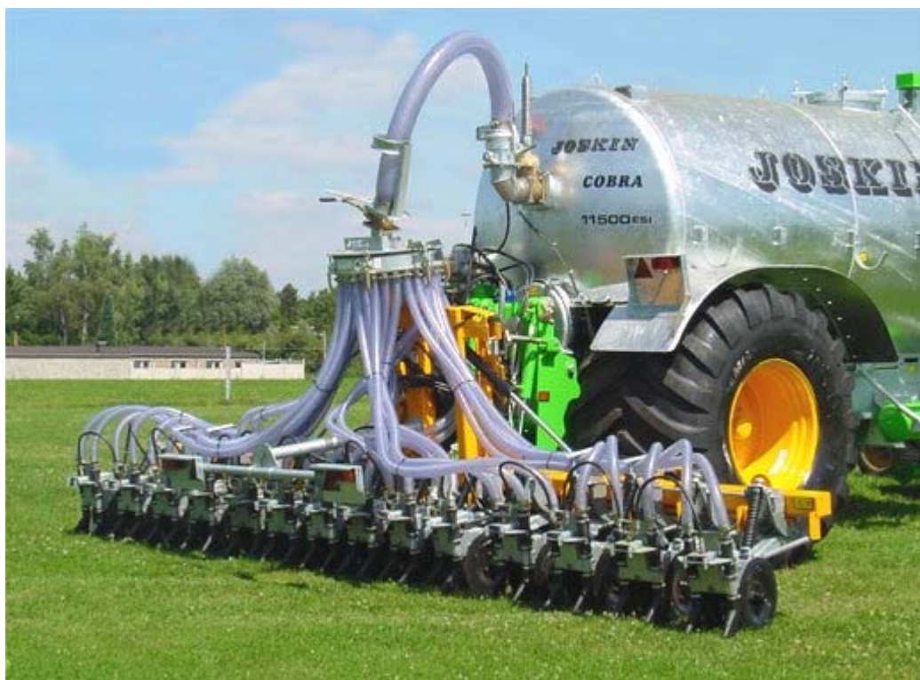
Joon. 9. Tihendusrataste ja sahkäppadega vedelväetusmasin (vt. ka joon. 6, d) [7, 8].
