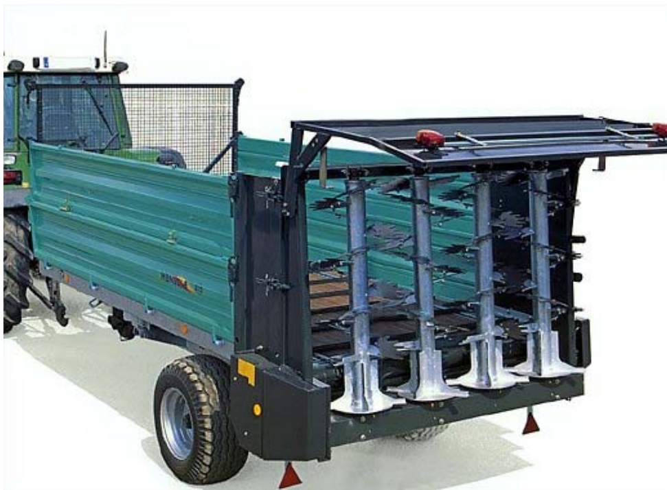
Joon.15. Nelja püstbiitriga ja nende all paiknevate rõhtketastega sõnnikulaotur [8].
