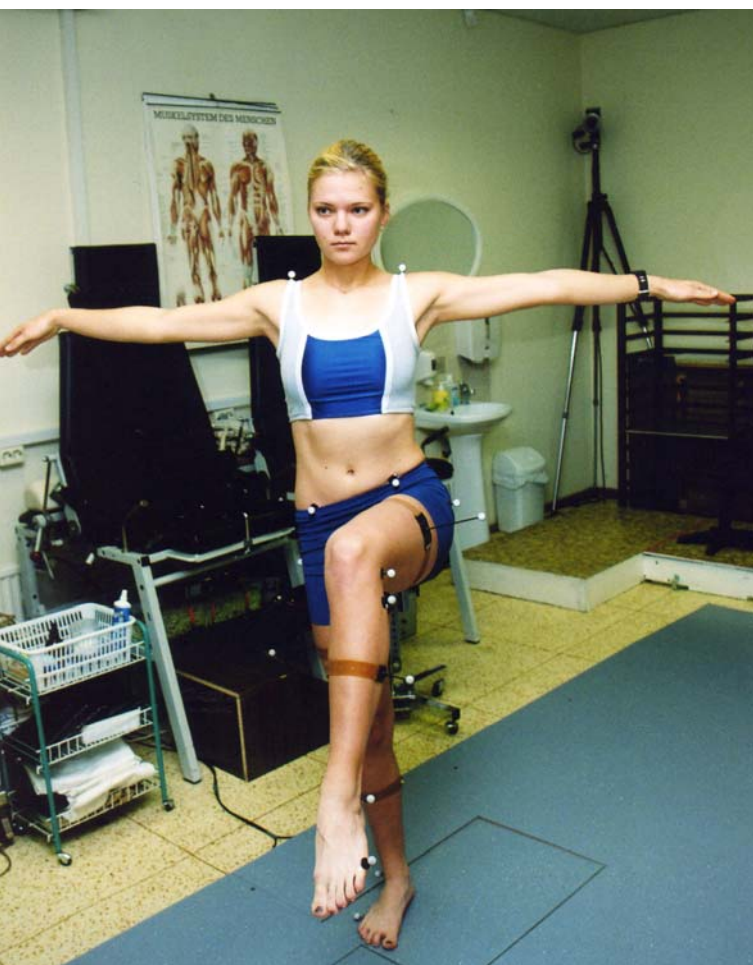
Liigutustegevuse biomehaanilised uuringud BTS ELITE 2002-ga.
