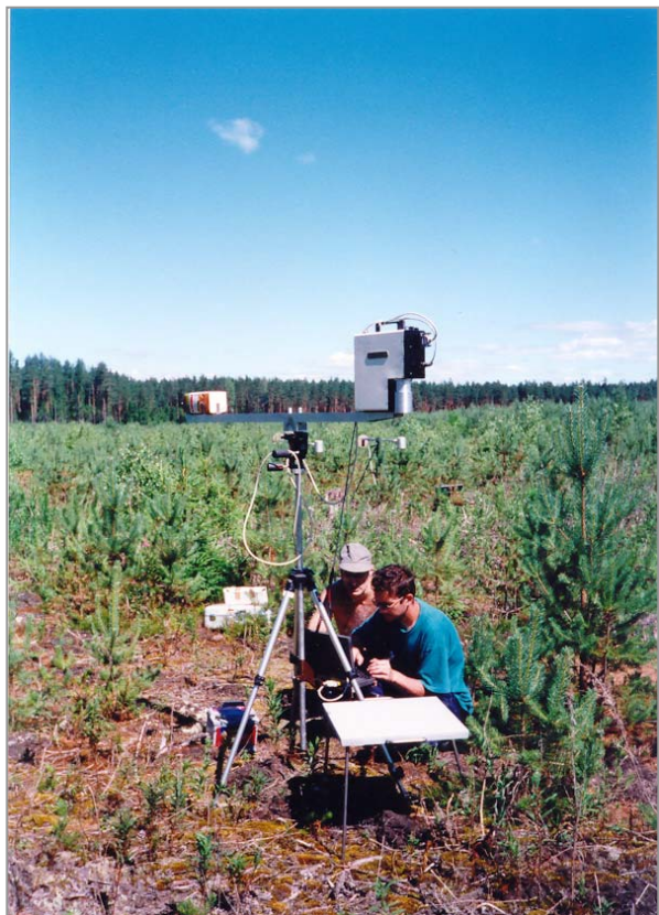
Välimõõtmised spektromeetriga (GER-2600) metsa- noorendikul Kongutas. Pildil vanemteadur A. Kuusk ja doktorand M. Lang spektromeetrit kalibrimas.
