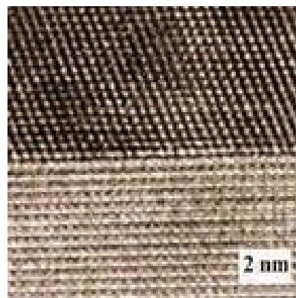
Joonis 2. Siirde \alpha\text{-Al}_2\text{O}_3 (all) – \text{SnO}_2 (ülal) aatomlahutusega elektron-mikroskoopkujutis.
