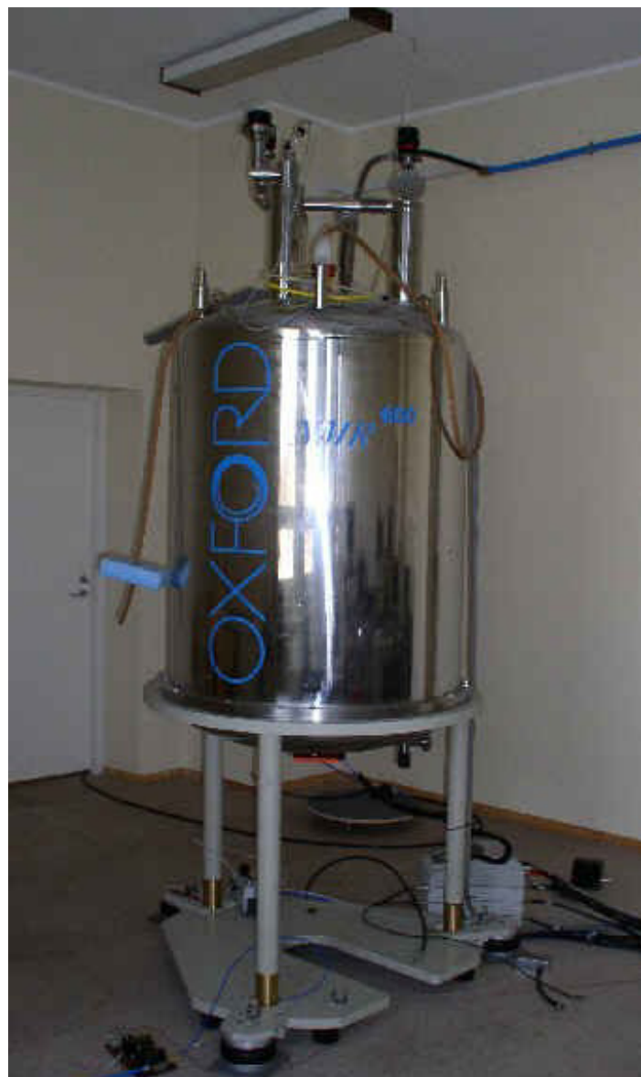
600 MHz-spektromeetri uus Oxford Instruments'i ülijuhtmagnet.
