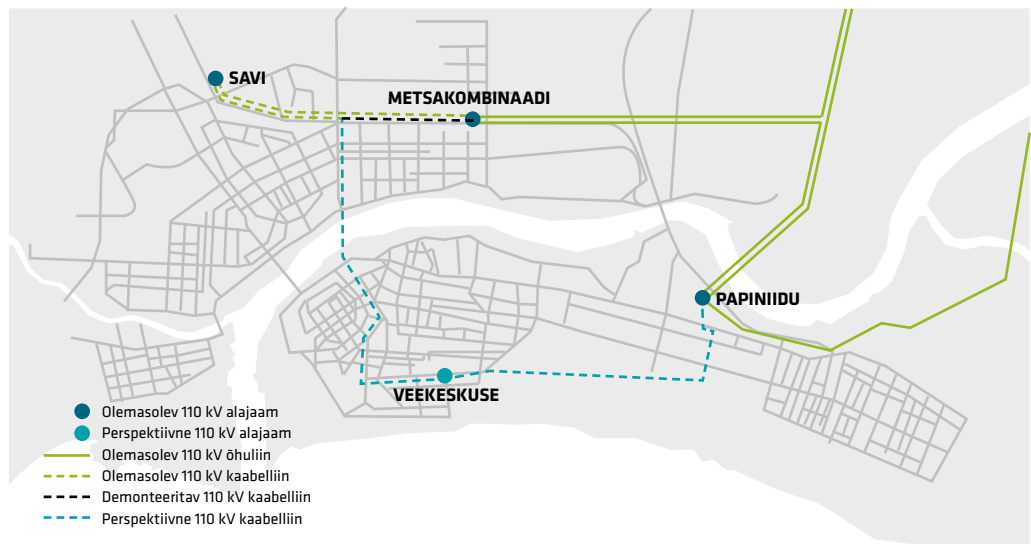
Joonis 13.2. Pärnu linna koormuste ümberjagamine uute 110 kV piirkonna- alajaamade vahel
