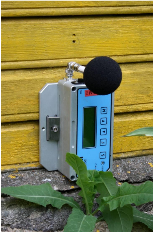
Pilt 1 Maja seinale kinnitatud vibromeeter koos helirõhumõõtjaga
