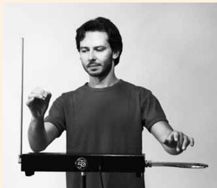
Taavi Kerikmäe Moogi tereminiga Etherwave. Vertikaalne antenn on helikõrguse, horisontaalne helitugevuse jaoks.
