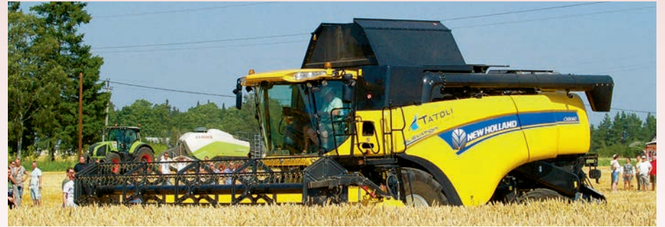
■ New Holland CX 8080 põikpeksuseadmele järgnevad massi peksujärgset liikumist ühtlustav vahebiiter ja põhu edasiande ühtlustamise trummel, mis jagavad pekstud massi kuuele põhupuisturile. Kombainil on aganalaotur. Puhastusseadme tööd juhivad optimeerimisautomaatika. Heedril saab muuta löikeseadme kaugust kaksikteost.
