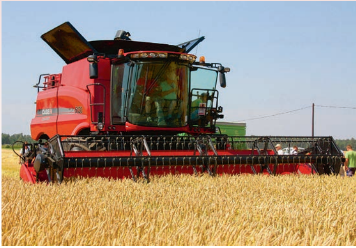
■ Case IH 5130 AT ühendatud peksu- ja eraldus-seadmeks on üks piki-asetuses rootor. Kombainil on aganalaotur. Heedril saab muuta löike-seadme kaugust kaksikteost.
