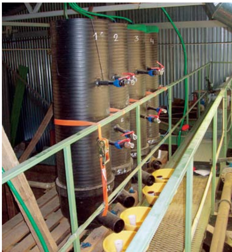
Eksperimentaalsed filtersüsteemid Väätsas prügila nõrgveet puhastamas.
