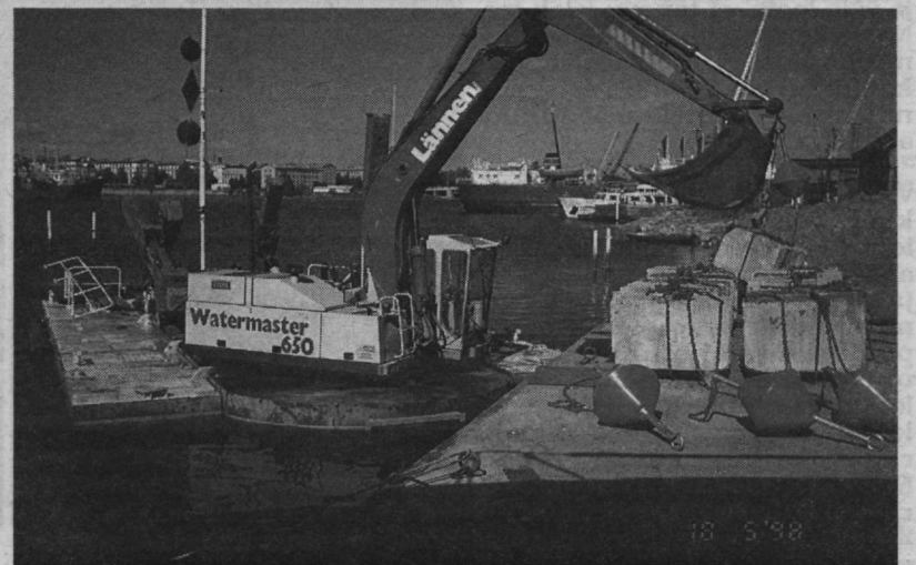
Süvendaja-ekskavaator Watermaster 650, registrinimega "Sini" pakib ankrupoisid koos raskustega tekile, et need pisut kaugemal õiges kohas vette lasta.
