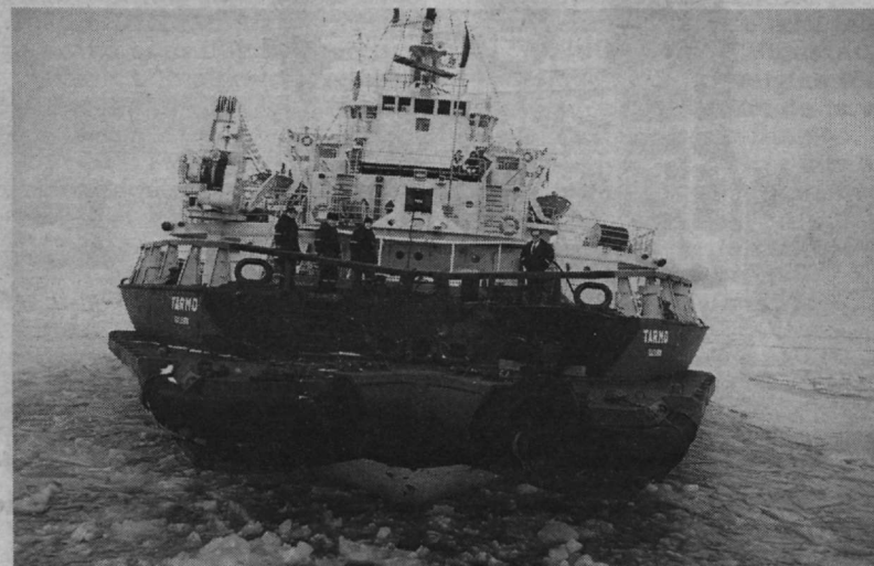
Kui laeva võõr tõmmatakse "Tarmo" ahtrisse, saab jääst kiiremini läbi. Muretumalt samuti.
