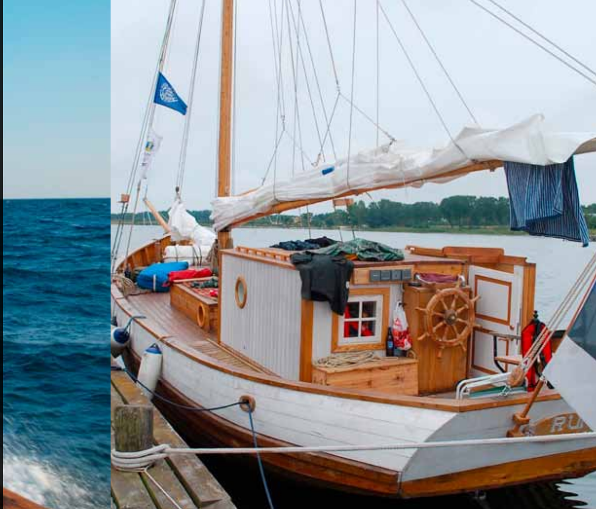
Jahtad on 1920-ndate aastate teisel poolel Ruhnus ehitatud 14-meetrised ühemastilised suure kahvelpurjega laevad. Nad on kaetud tekiga ning nende otstarve on sama, mis ligi neli meetrit lühematel jaaladel – hülgepüük, kuid ka kaubavedu. Teadaolevalt ehitati Ruhnus kokku 8 jahtat.
