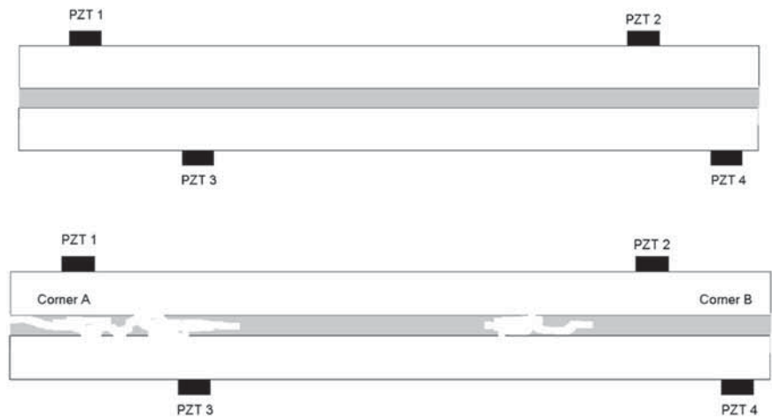
Joonis 1. Tuulikulaba enne (a) ja pärast struktuurimuutusi
