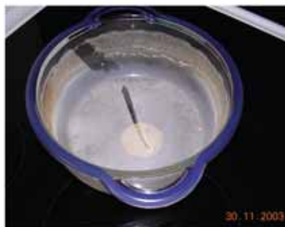
Joonis 2. Magnetitöödeldud vee sadet saab sõrmega ära pühkida
