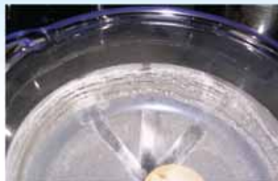
Joonis 1. Magnetiseerimata veest tekkinud katlakivist ei saa sõrmega puhast joont läbi tõmmata – sade on nõu pinna küljes tugevasti kinni
