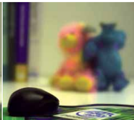
Uus fookus. Levin ja tema kolleegid töötasid välja eri läätsest ruudustiku, mis pannakse kaamera tavaliisele objektiivile. Iga lääts fookustab kaamerast eri kaugusel olevale alale. Kõikidest läätsest saadud andmete abil saab Levin valida, millisele osale fotost fookustada. Vasakpoolisel pildil on fookuses arvutihir. Parempoolisel pildil on ta fookuse nihutanud taustal olevatele mänguasjadele. Allikas: Levin, Hasinoff, Green, Durand, Freeman „4D Frequency Analysis of Computational Cameras for Depth of Field Extension”.
