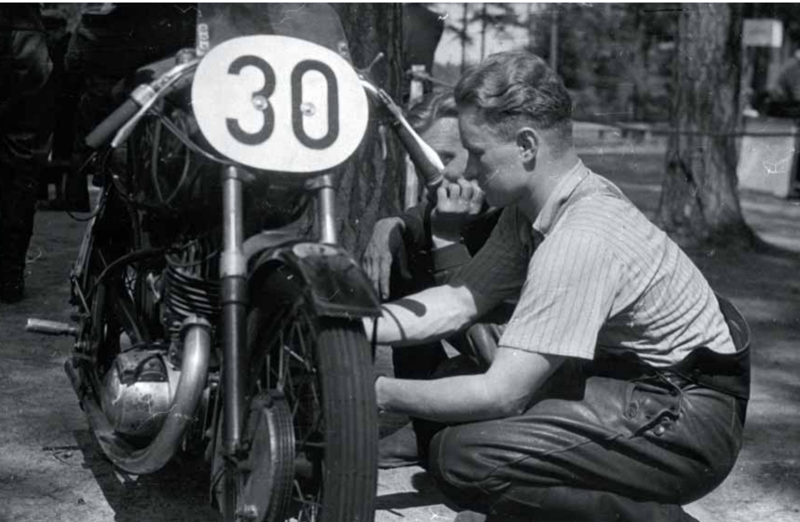
Ervin putitamas oma IZ'i Pirita ringraja boksis. Selgelt on näha toonastele ringrajamootorrataste iseloomulik pööratud juhtraud, isetehtud väike tuuleklaas ning mootori parempoolse küljekaane alla peidetud magneeto.
