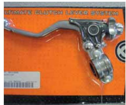
Vajadusel saab asendada kogu sidurilingisüsteemi uue ja reguleeritava.
