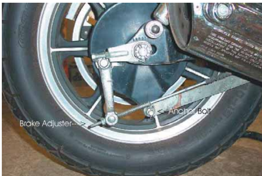
Tagapiduri kulumisastmest räägib pisut pidurikaanele kantud skaalale viitav osutike pidurihoova all (keskel, ketipinguti ääre all).
