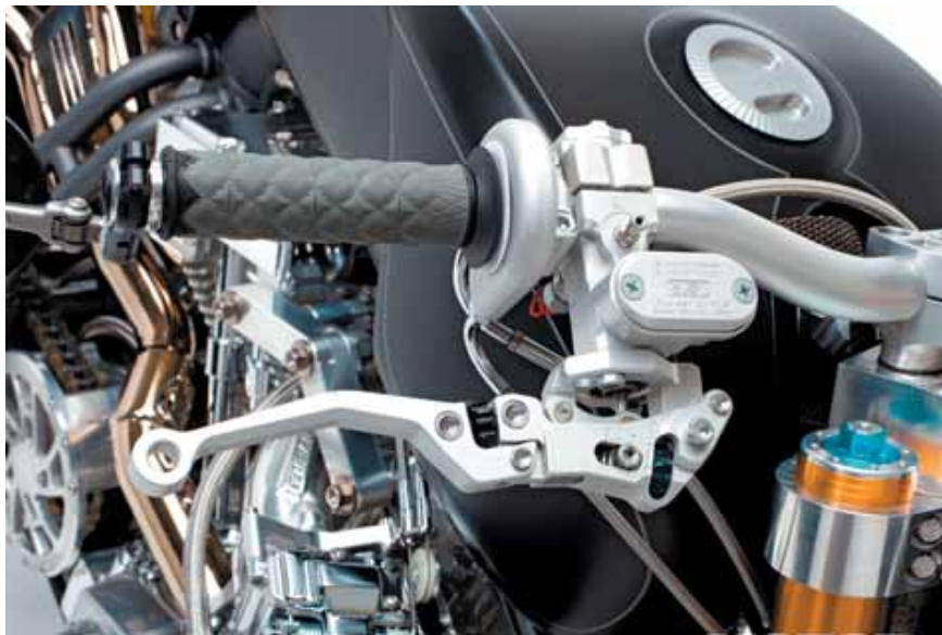
Kõige kallim, aga ka radikaalsem tee oma piduritunnetust parandada - vahetada välja terve piduri peapump. Siin on üks kallim võimalus - ISR radiaalse pumbaga komplekt.
