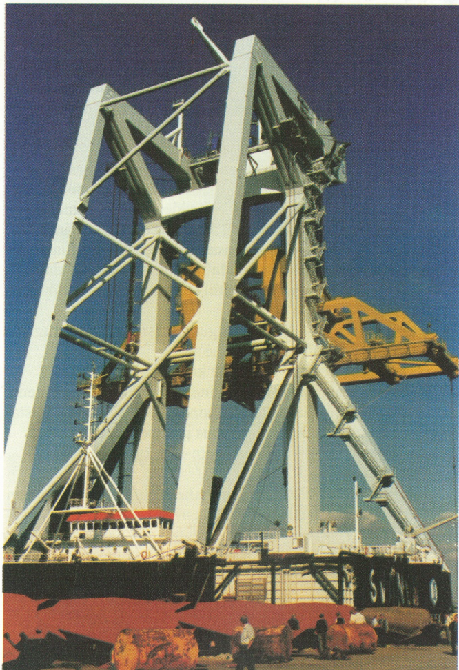
Selle 10 000-tonnise tõstejõuga ujukraanaga tõsteti paika Suur-Beldi ja Öresundi silla suured plokid. Foto: Allan Allik
