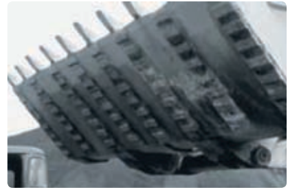
► KOPA PÕHI ON KAETUD VAUTID KOMPOSIITPLAADIGA, KIHVAD PINNATUD VAUTID ELEKTROODIGA
