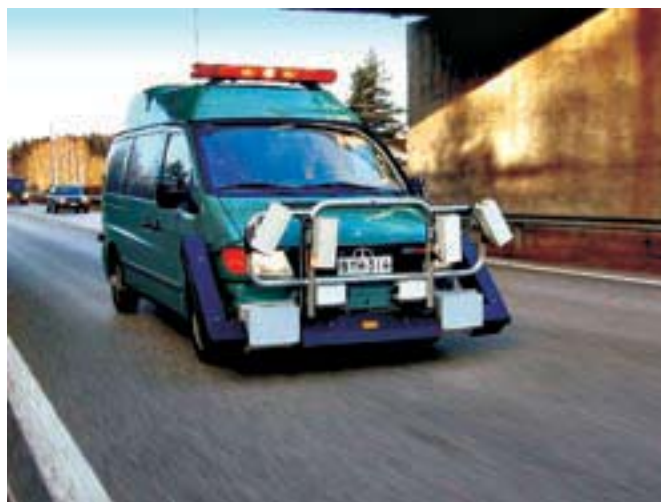
Pildil on VTT (Soome Riiklik Tehnouringute Keskus) PTM-auto, millega saab mõõta nt teepinna roopasügavusi ja pikisuunalist ebatasasust.
