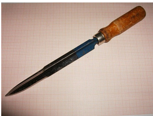
Joonis 4.13. Kolmnurkse ristlõikega kaabits (A), liugelaagri käsitsi kaabitsemise (B) [20]
