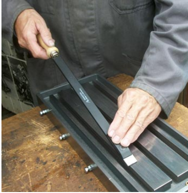
Joonis 4.14. Juhtpinna käsitsi kaabitsemine (A), juhtpinna kaabitsemine elektrikaabitsa- ga (B) [21]
