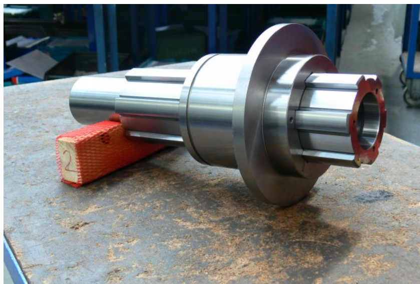
Joonis 5.23. Rööpprofiiliga hammasliide [31]
