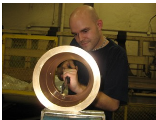
Joonis 4.13. Kolmnurkse ristlõikega kaabits (A), liugelaagri käsitsi kaabitsemise (B) [20]
