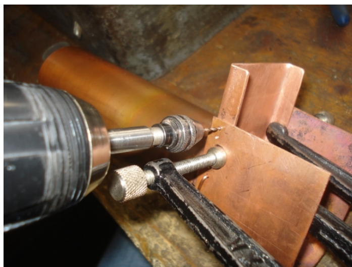
Joonis 4.5. Avade puurimine ühe läbimiga liidetavates detailides [17]
