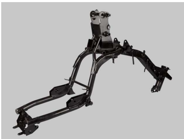
Joonis 5.14. Rakises koostatud “kerge” keeviskonstruktsioon [11]
