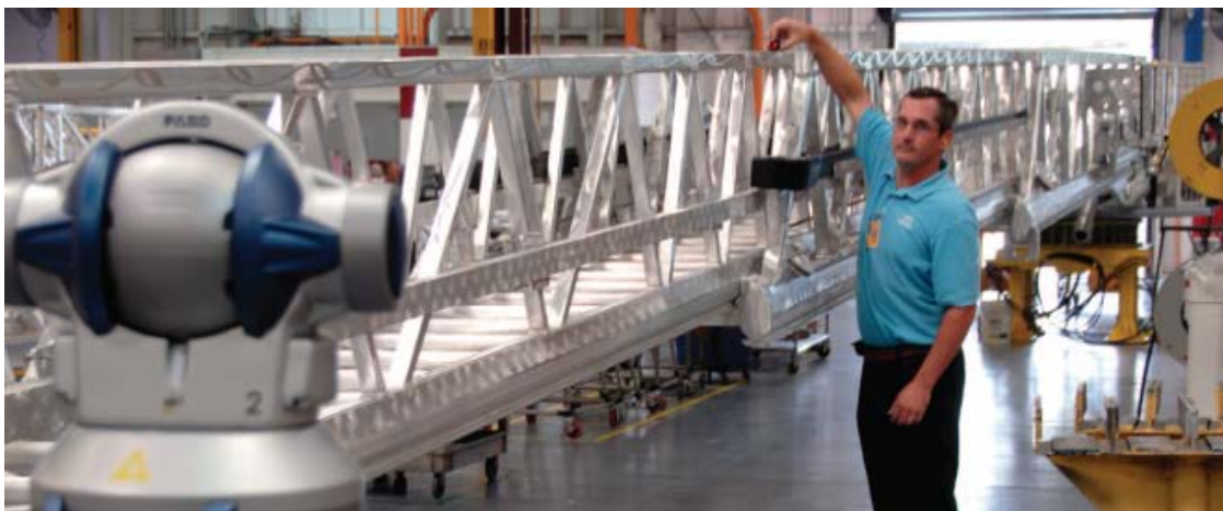
Joonis 5.34. Suuregabriidilise metallkonstruktsiooni mõõtmine laserseadme abil [36]
