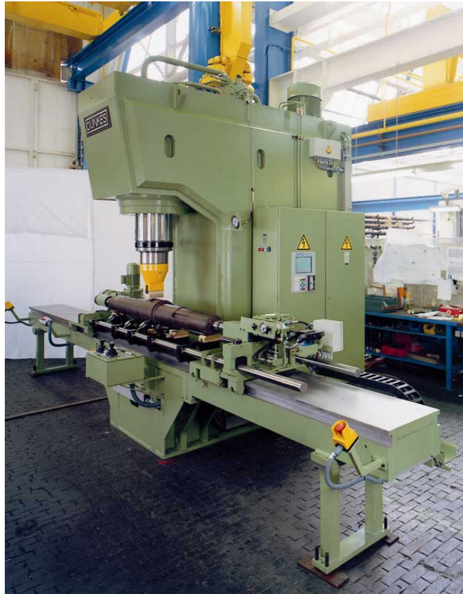
Joonis 3.27. Vertikaalne hüdrauliline press võimsusega 15000 kN [13]
