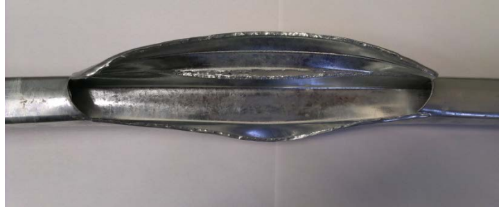
Joonis 6.6. Tehnoloogiliste avade puudumise tõttu lõhkenud toru
