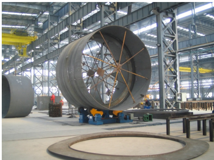
Joonis 5.31. Rullikud silindriliste konstruktsioonide pööramiseks [34]
