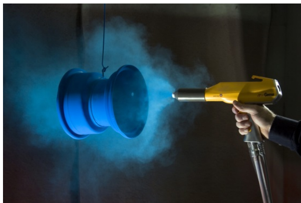
Joonis 6.4. Pulbervärvi pealekandmine värvipüstoliga [45]
