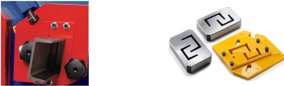
Joonis 3.20. U-profiili tükeldamine presskäärides (A) ja seadme vahetatavad matriit- sid (B) [8]
