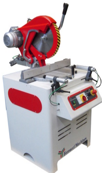
Joonis 3.22. Ketassaag metalli lõikamiseks [10]
