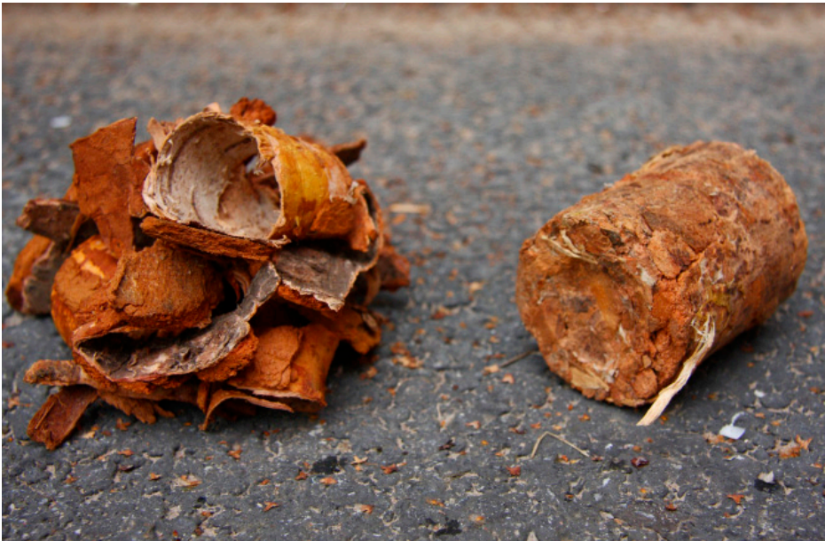
Joonis 2. Kasekoor ja sellest valmistatud silindriline presstoode (Foto autor Kaspar Dobrus) Figure 2. Raw material and produkt (Photo Kaspar Dobrus)
