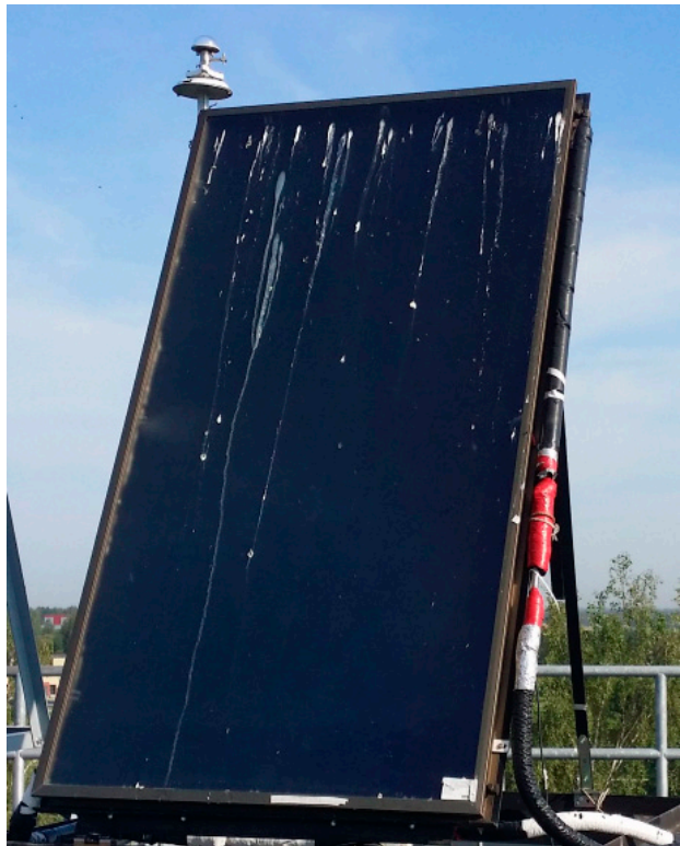
Joonis 6. Lindude poolt tekitatud kahjustus fooliumkatele Figure 6. Damage of the aluminium foil caused by birds
