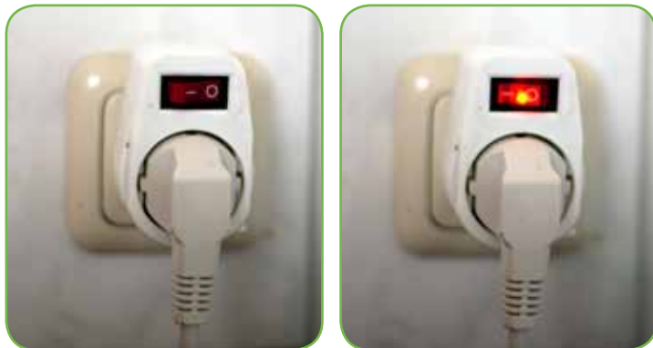
Joonis 5 Lülitiga pistikupesade kasutamine võimaldab seadmeid mugavalt välja lülitada | Pildid: P. Engewald
