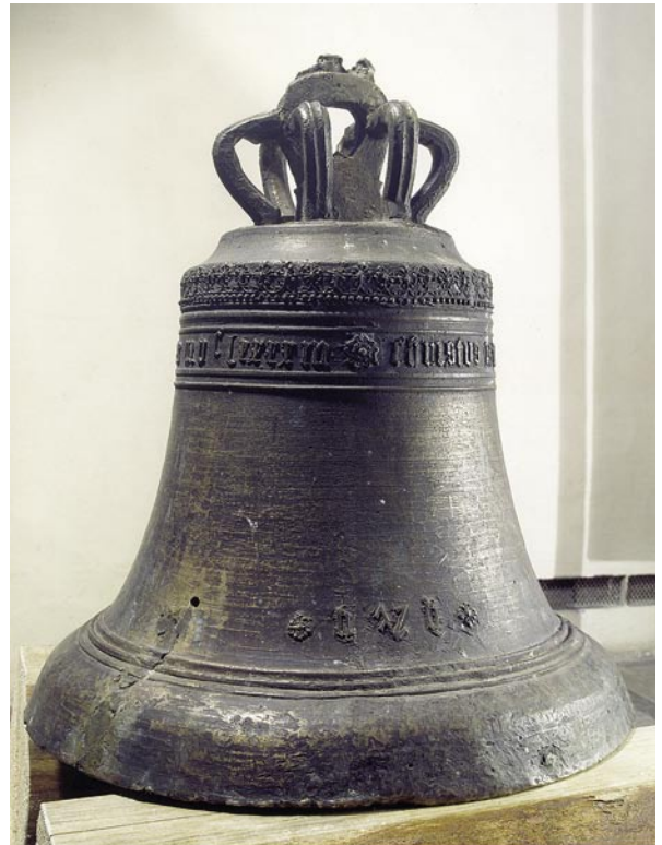
55. Asjatundmatu kasutamise tõttu mõranenud kell. Sellist kella ei tohi enam helistada ega lüüa. Foto P. Säre
