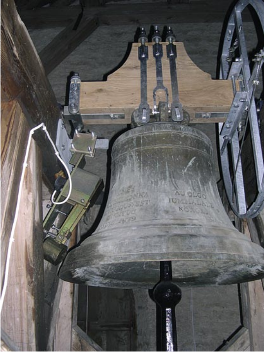
53. Elektrilise löögimehhanismiga kell. Foto T. Mäeväli
