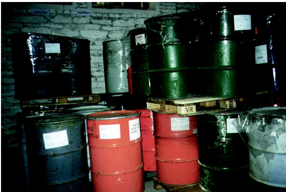
2 – Vältimaks pinnase ja põhjavete reostumist, koguti ohtlikud jäätmed kokku ja ladustati kaanega suletavatesse metallvaatidesse. Saku jäätmehoidla. Toomas Lambuti foto.
