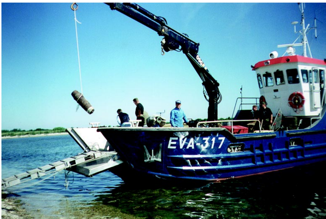
1 – Demineerimistöodel saartel kasutati Veeteede ameti EVA-tüüpi laeva, mis madala süvise tõttu sai sõita otse randa. Mati Mullase foto.
