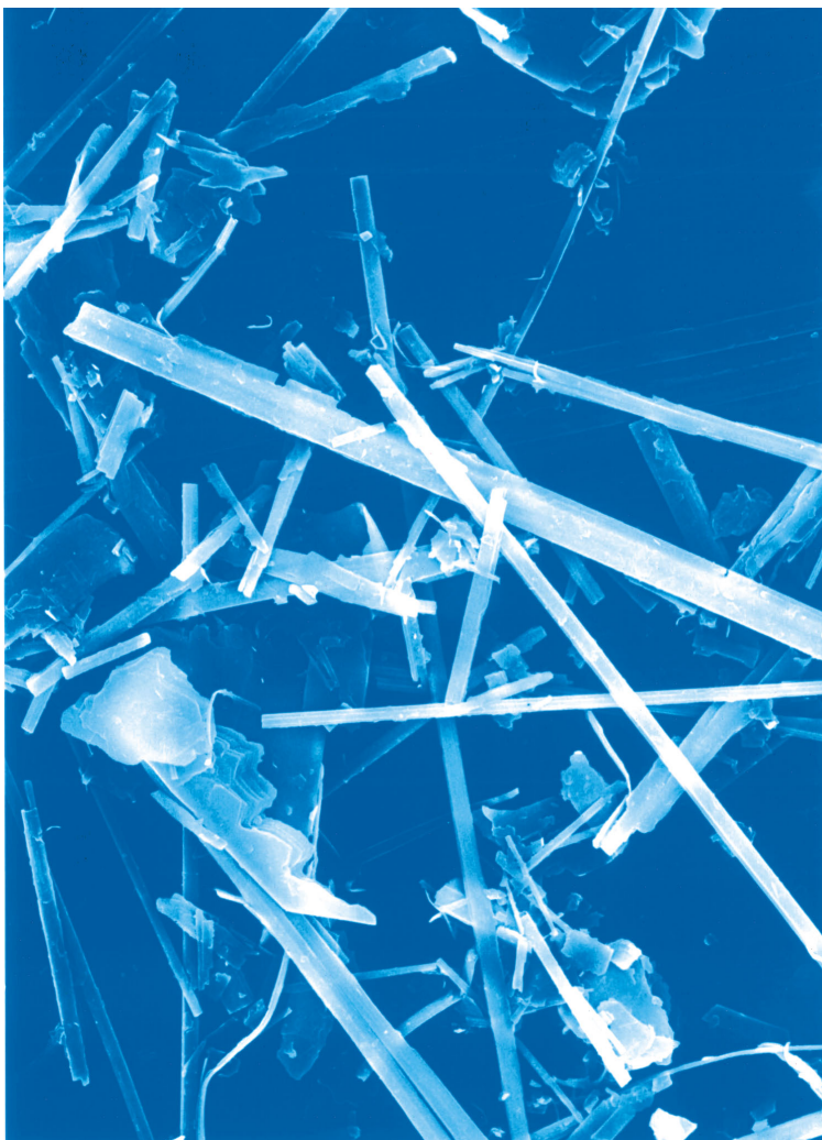
Foto 3. Asbestikiudude 2000 kordne suurendus: peenimad asbestikiud on alla 1 mikromeetri.
