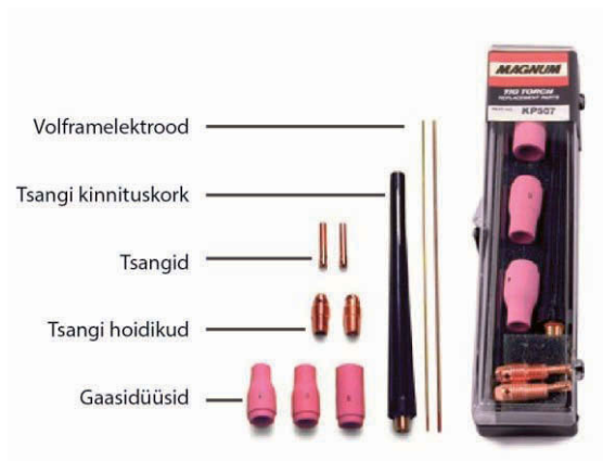
Joonis 4.42. TIG-keevituse põleti vahetatavate detailide komplekt [7]
