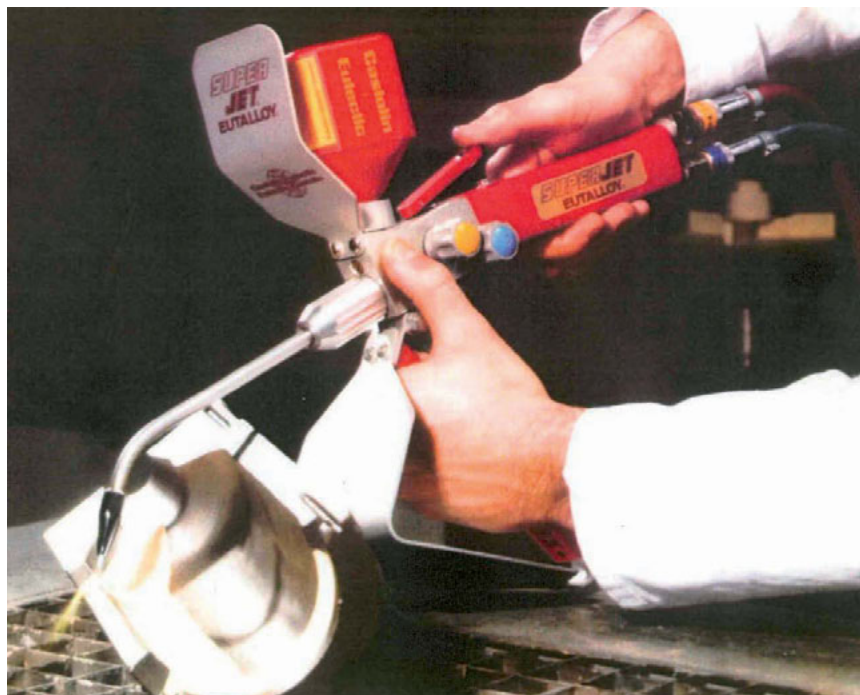
Joonis 4.68. Gaasileekpealekeevitus kulunud pinna taastamiseks
