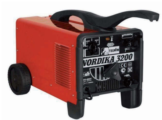
Joonis 4.6. Keevustrafa Nordika 3211, 55...160 A, võimsus 2,5 kW, elektroodi läbimõõt 2,0...4,0 mm
