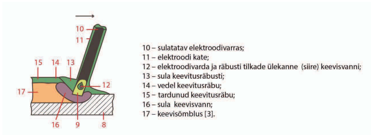
Joonis 4.3. Käsikaarkeevitus: 10 – sulatatav elektroodivarras, 11 – elektroodi kate, 12 – elektroodivarda ja räubusti tilkade ülekanne (siire) keevisvanni, 13 – sula keevitusräubusti, 14 – vedel keevitusräbu, 15 – tardunud keevitusräbu, 16 – keevisvann, 17 – keevisõmblus [3]
