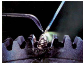
Joonis 4.63. Hammasratta taastamine pealekeevitusega
