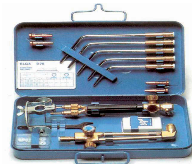
Joonis 4.59. Mitmeotstarbeline gaaskeevituse ning -lõikamise komplekt Elga D 75
