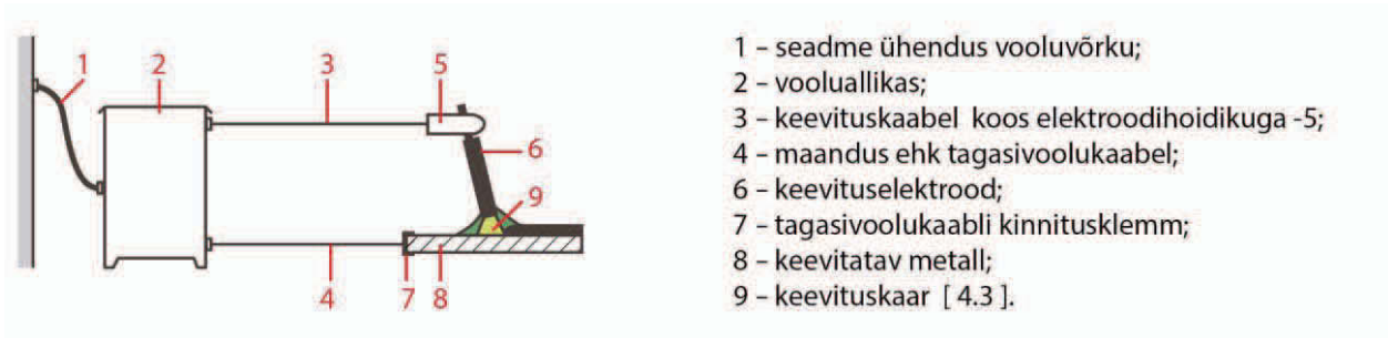
Joonis 4.2. Käsikaarkeevituse üldskeem: 1 – seadme ühendus vooluvõrku, 2 – vooluallikas, 3 – keevituskaabel koos elektroodihoidikuga, 4 – maandus ehk tagasivoolukaabel, 5 – elektroodihoidik, 6 – elektrood, 7 – tagasivoolukaabli kinnitusklemm, 8 – keevitav metall, 9 – keevituskaar
