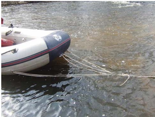
Joonis 111. Nõöri paadi vööri kinnisidumine.
