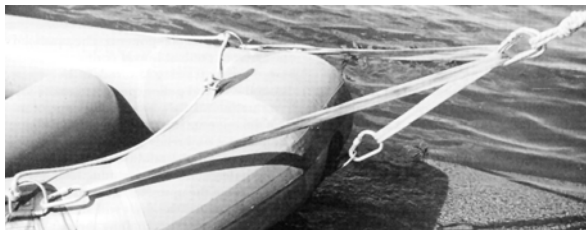
Joonis 112. Slingiga paadi vööri kinnisidumine.
