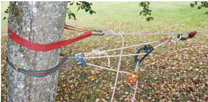
Joonis 117. Põhinööri pingutamine, kus pinge jääb ainult põhinöörile, mitte nööri tagasilaskmise takistamiseks mõeldud töövahendile.
