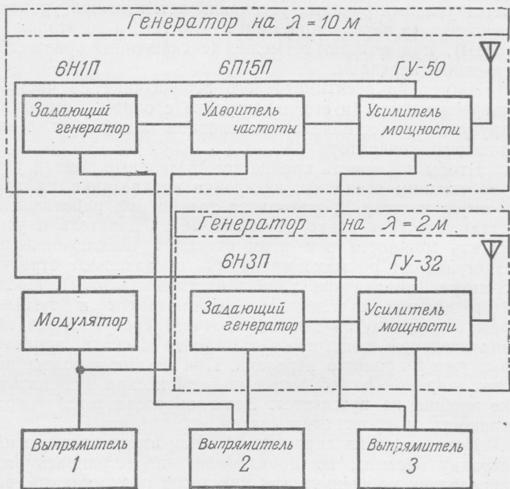
Рис. 2. Блок-схема передающей части радиостанции ШК-2
