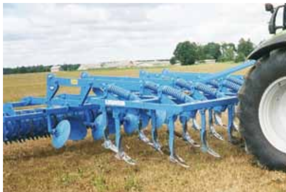
Joonis 4. Rull-käpprandaal tihenenud muldadele
