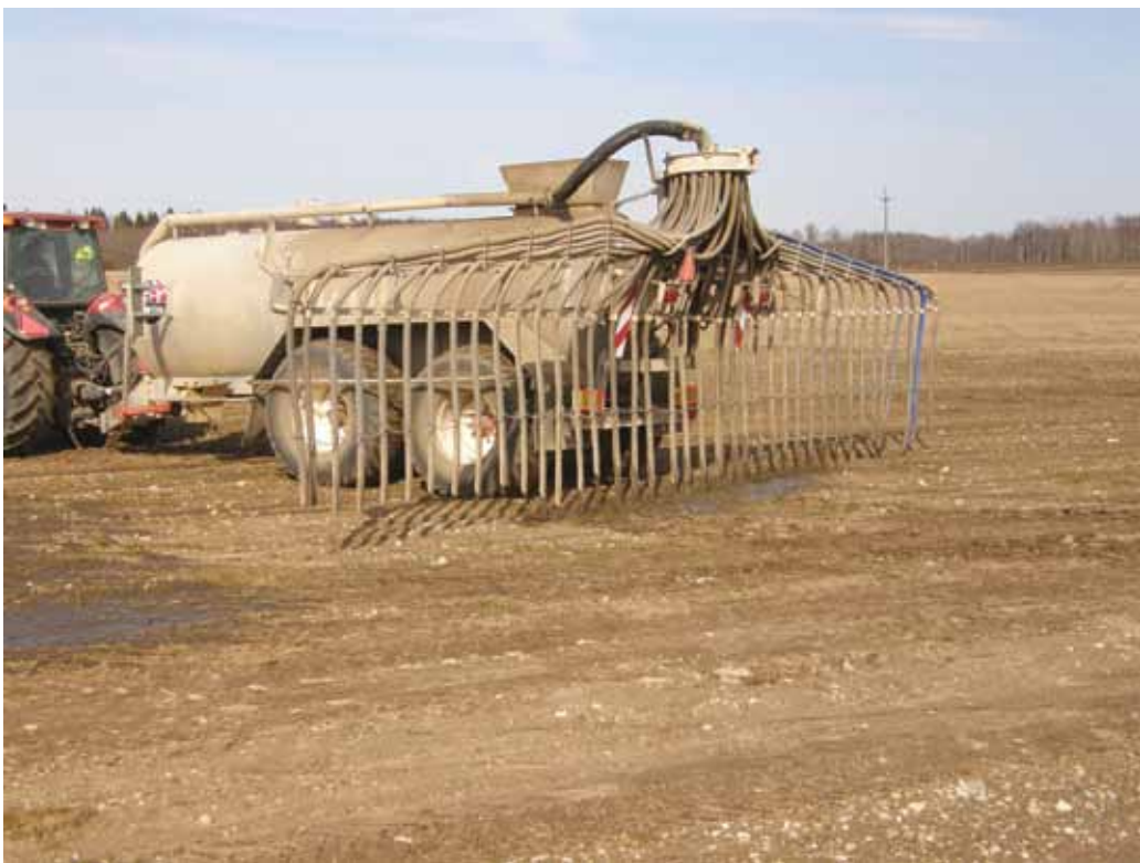
Joonis 3. Lohisvoolikutega laotatud vedelsõnnik vajab kohest muldasegamist
