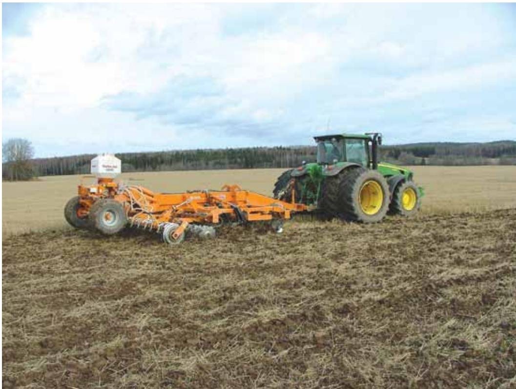
Joonis 29. Rapsitehnoloogia – mullaharimine ja külv ühe töökäiguga
