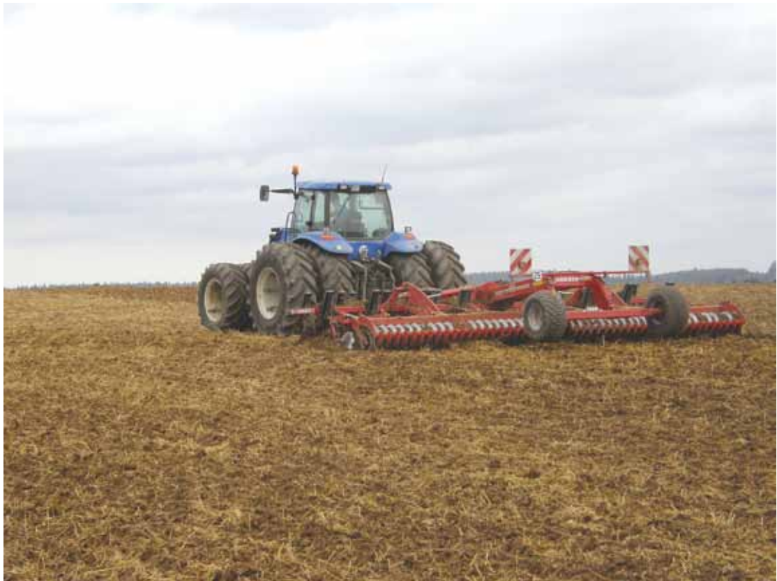
Joonis 4. Tihenemata muldadel tuleks vedelsõnnik mulda segada rullrandaaliga
