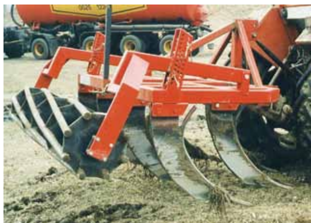
Joonis 1. Sügavkobesti tihenenud muldadele
