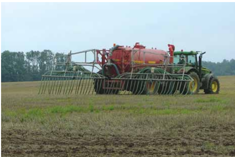
Joonis 25. Vedelsõnniku laotamine lohisvooliklaoturiga
