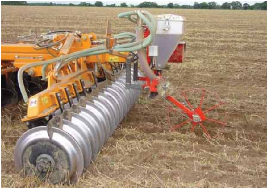
Joonis 8. Mullaharimise ja külvi põimargaat peenseemnetele
