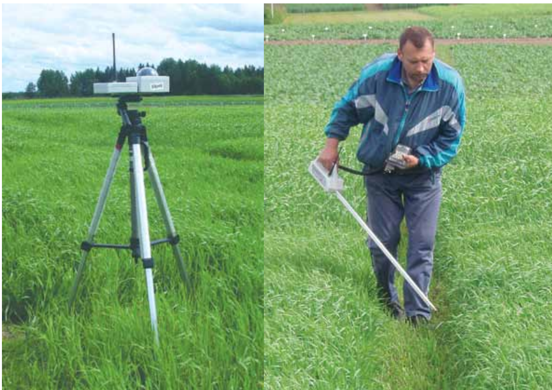
Joonis 1. Külvi kohale paigutatud kiirguse andur koos raadiosaatjaga (vasakul) ja mõõtja koos kiirguse mõõtmise lati ning pihuarvutiga (parempoolsel fotol)
