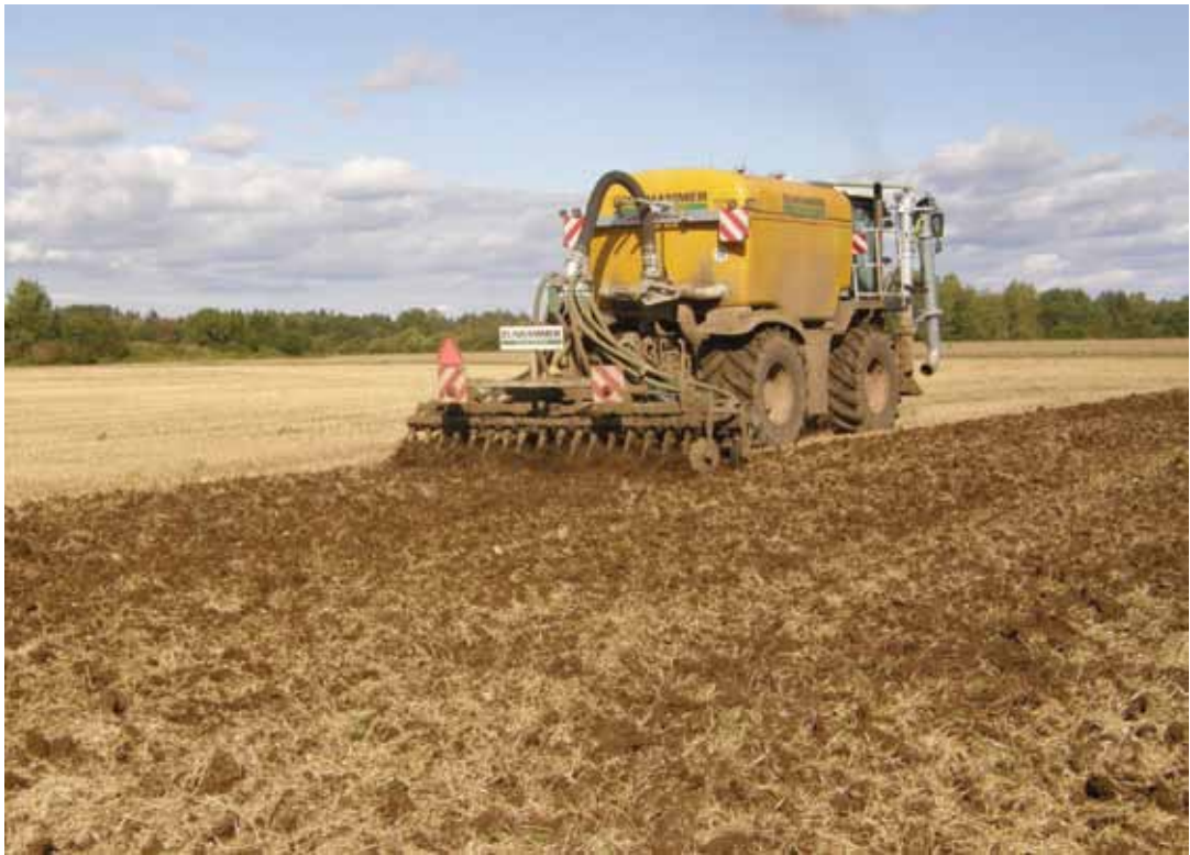
Joonis 26. Muldaviimisseadisega vedelsõnnikulaotur
