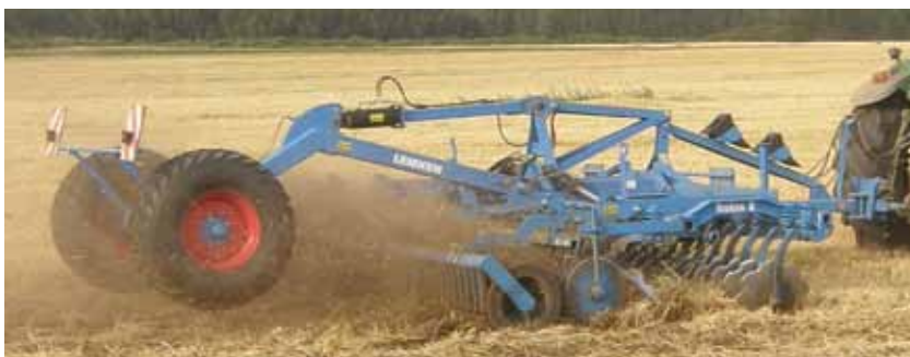
Joonis 5. Rullrandaal kerge ja keskmise löimisega muldadele
