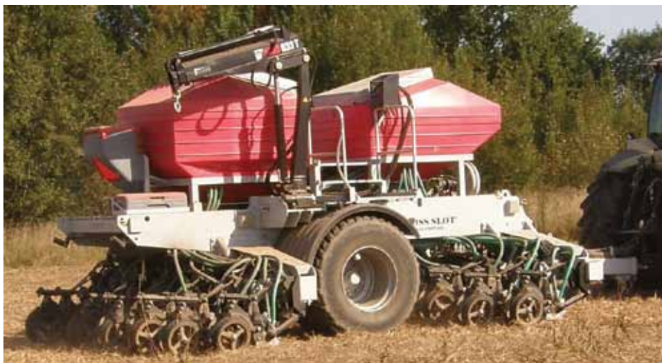
Joonis 15. CROSS-SLOT otsekülvik sobib ka rapsi külviks
