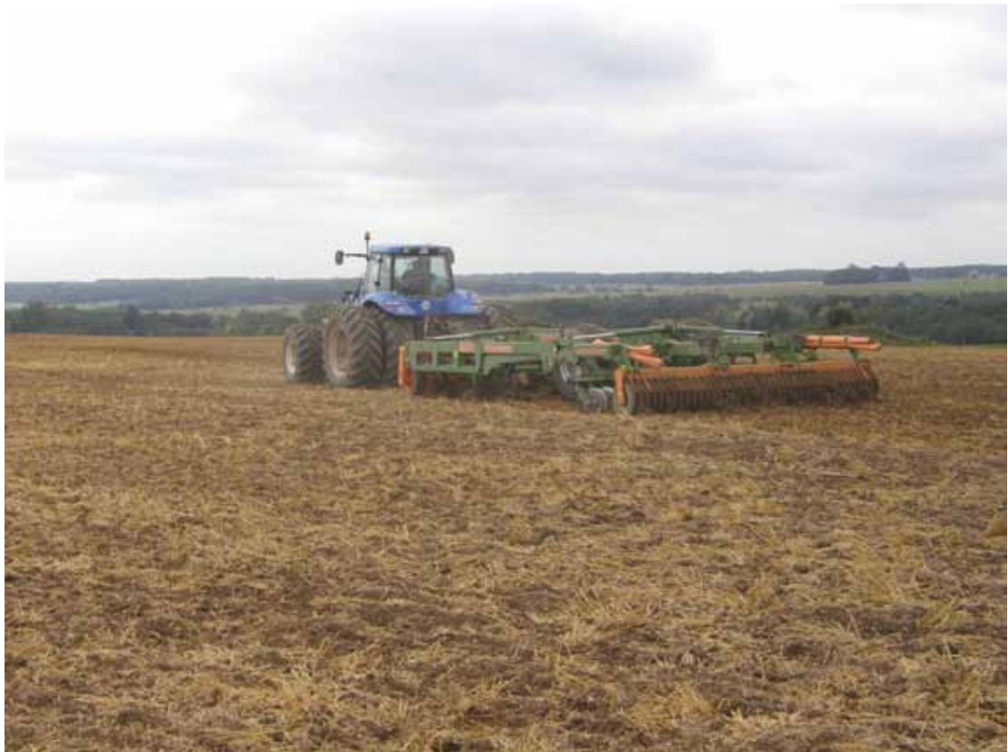
Joonis 5. Tihenenud muldadel tuleks vedelsõnnik mulda segada rullkäpp-randaaliga
