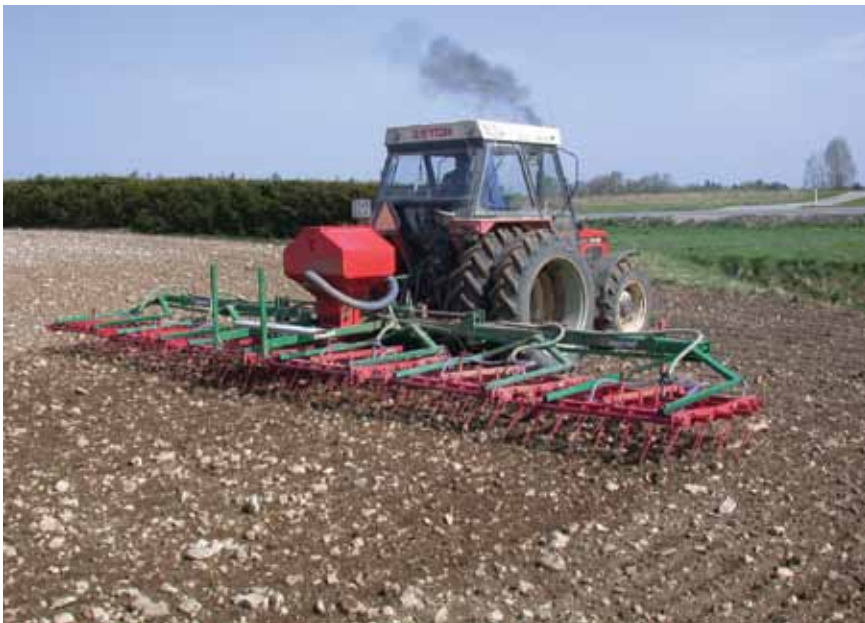
Joonis 9. Peenseemnete külvik ökoäkkel
