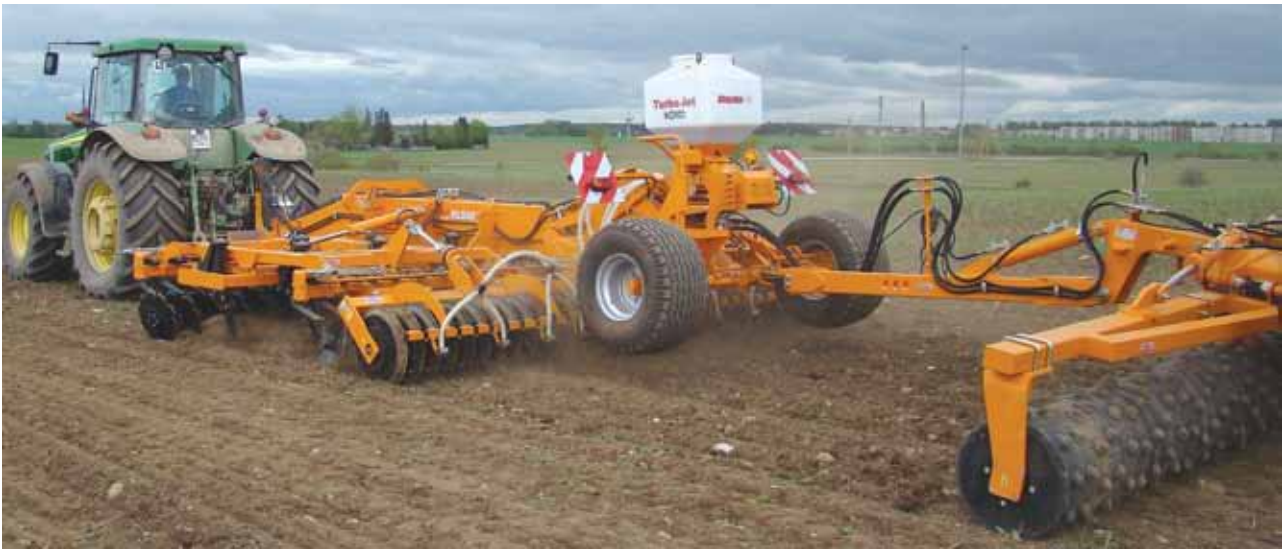
Joonis 13. Mullaharimise ja külvi pöimmasin SIMBA 500SL
