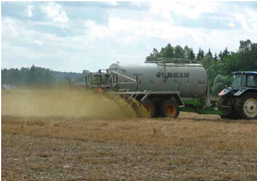
Joonis 24. Vedelsõnniku laotamine paisklaoturiga
