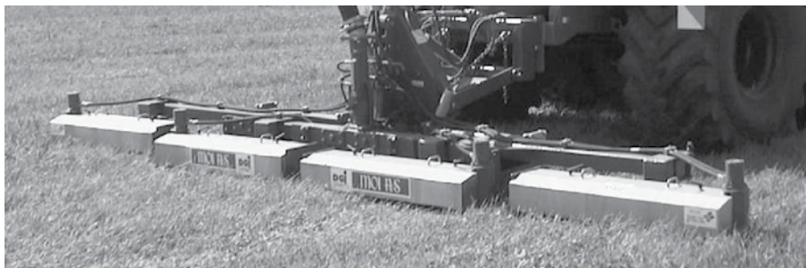
Joonis 4. Vedelsõnniku muldaviimine surve-laotusega
