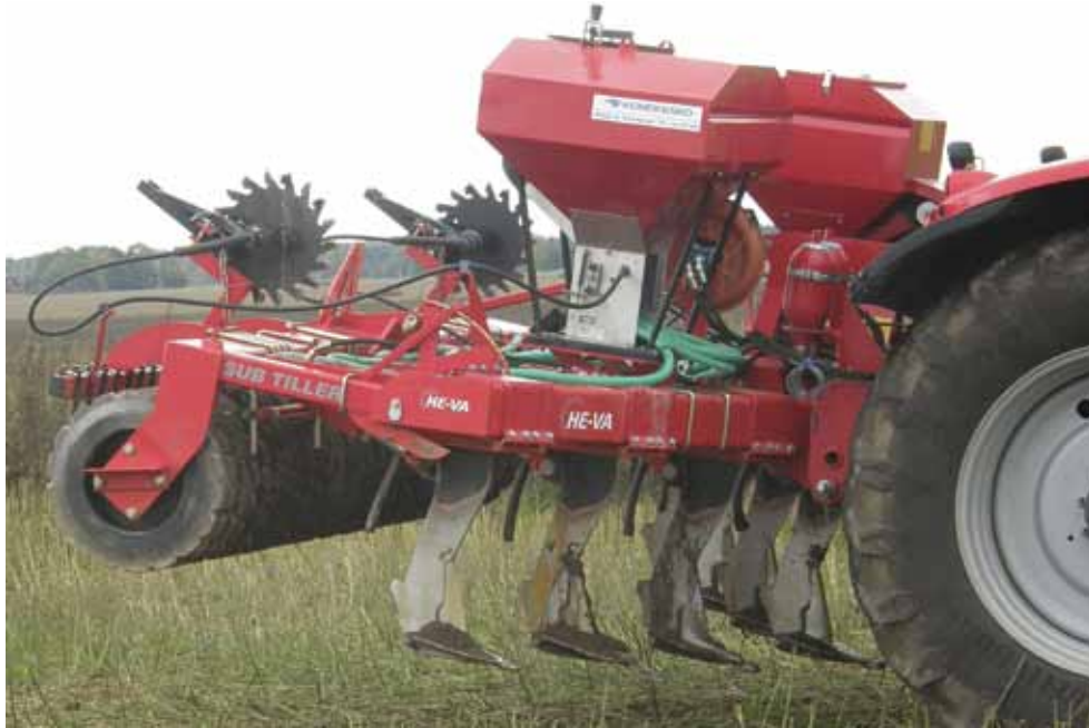
Joonis 2. Sügavkõrestuse ja külvi põimmasin rapsi viljelemiseks tihenend muldadel
