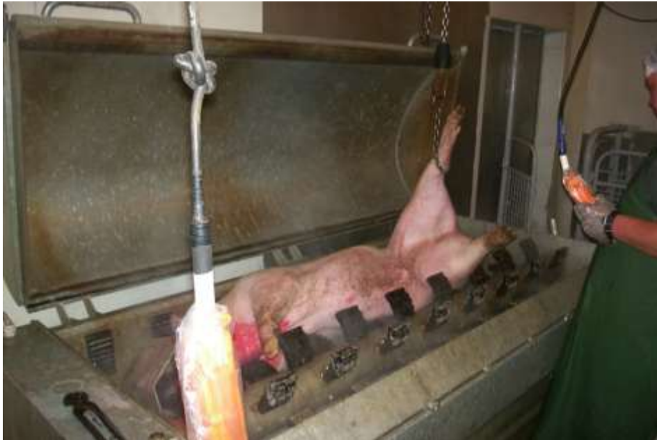
Joonis 17. Sea lihakeha laskmine kupatus-kaapmasinasse telfri abil
