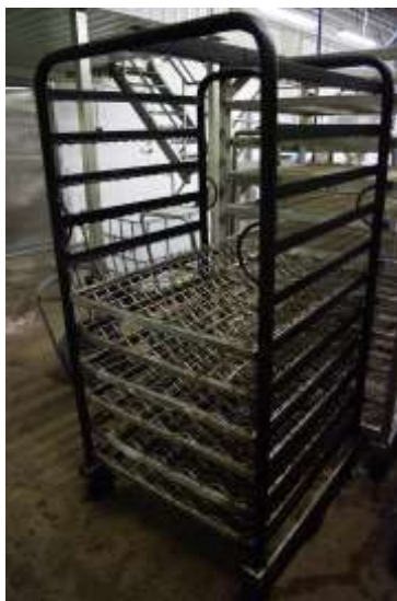
Joonis 75. Termokambri raam suuremõõtmeliste batoonide töötlemiseks
