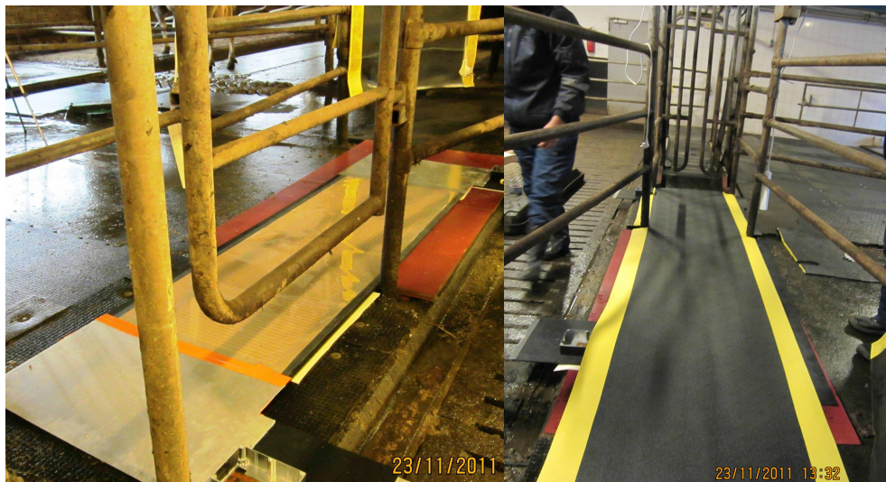
Joonis 2. A – Tekscani surveandurid B – kaitsematiga kaetud surveandurid
