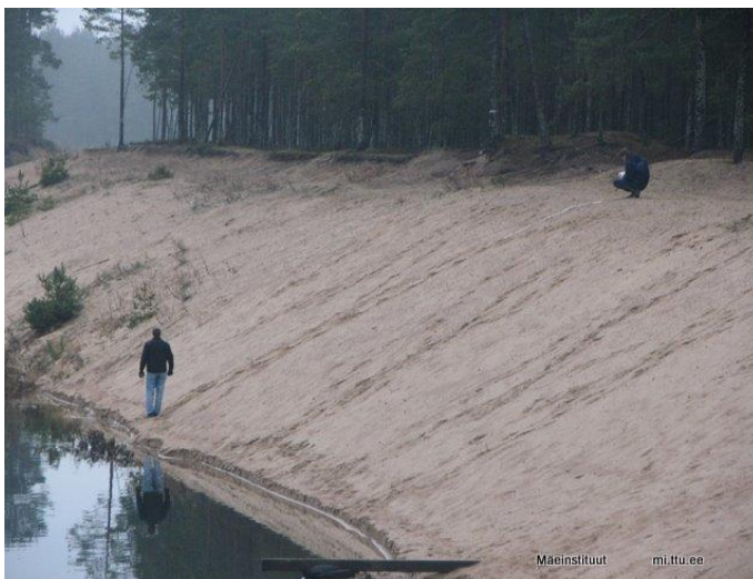
Joonis 65 Karjääri nõlva pikkuse mõõtmine
