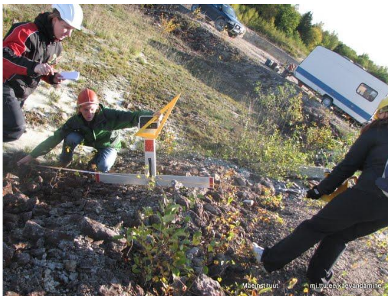
Joonis 26 Karjääri elementide - astangute, rampide, puistangute möõtmine laserite, nurgamööõtjate ja GPS-idega
