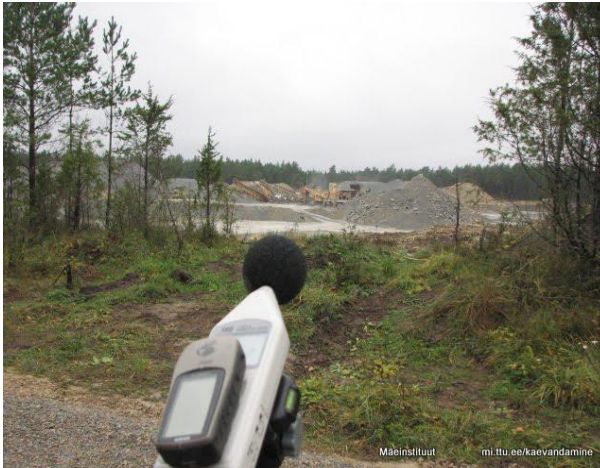
Joonis 40 Karjääri mürataseme mõõtmine
