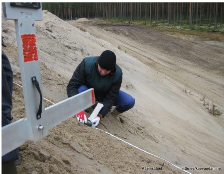
Joonis 33 Settekaardi nõlva pikkuse ja varingukaldenurga mõõtmine
