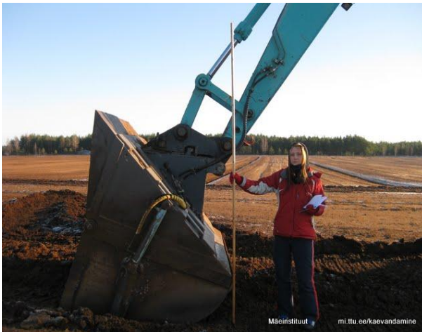
Joonis 50 Masinate parameetrite mõõtmine, alltühjendatava pärikopaga laadimisekskavaator
