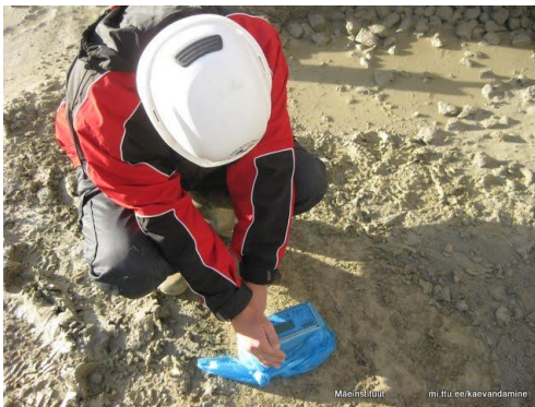
Joonis 28 Vibratsiooni mõõtmine seisimeetriga
