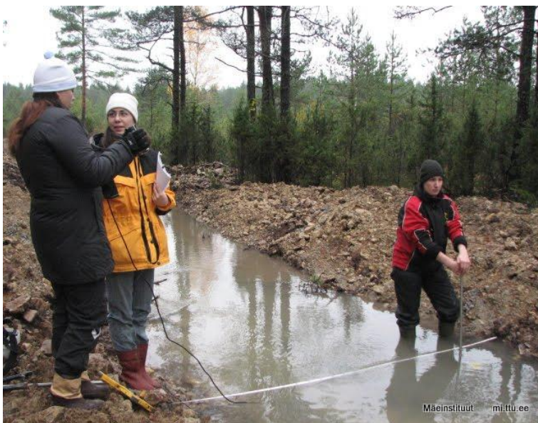
Joonis 42 Väljapumbatava vee vooluhulkade määramine äravoolukraavis
