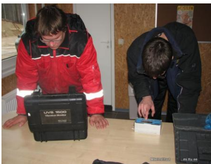
Joonis 54 Vibratsiooni mõõtmisseadmete sünkroniseerimine
