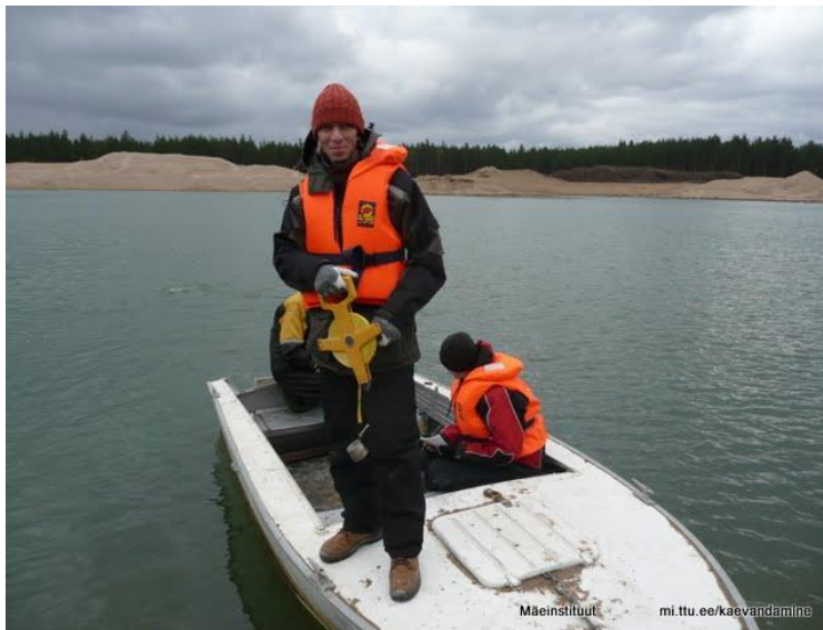
Joonis 34 Karjääri põhja ja nõlva mõõtmine
