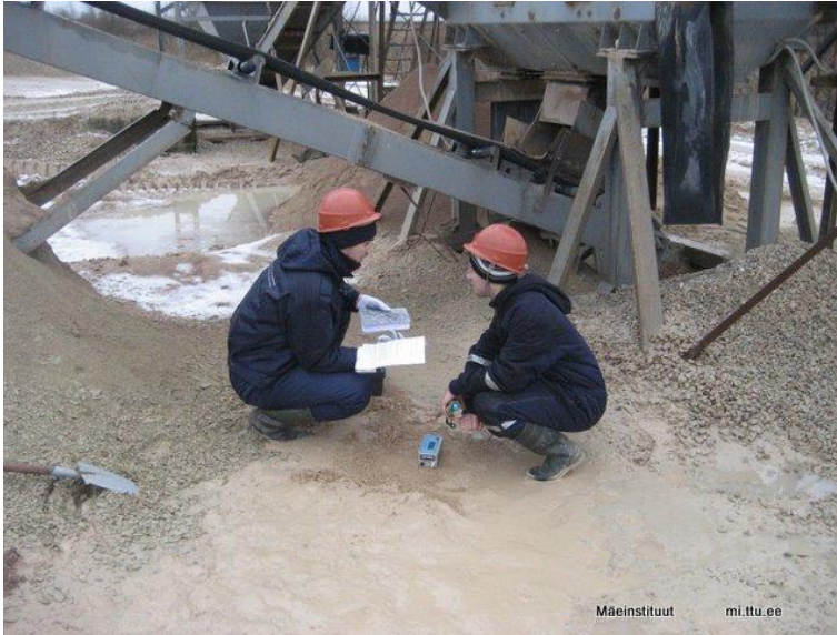
Joonis 55 Purusti vibratsiooni mõõtmine
