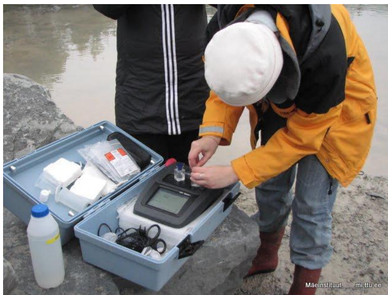
Joonis 43 Settebasseini vee olukorra analüüsimine
