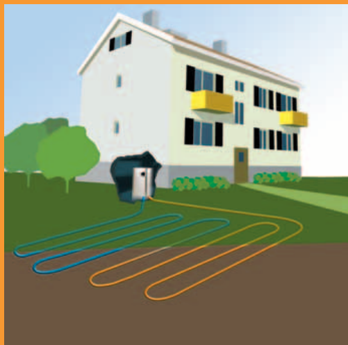
15 Soojuspumba maakontuur kaevatakse pinnasesse.
