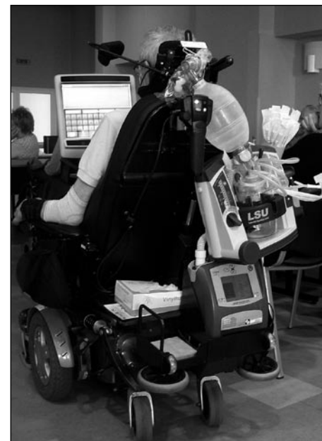
Leia pildil ALS-ga inimese tavapärase varustuse osad nagu: hingamisaparaat, elektriline aspiraator koos eritiste kogumise nõuga, imemisotsikute tagavara aspiraatorile, amb, kummikinnaste varu isiklikule abistajale, silmavaatele reageeriv arvutisüsteem My Tobii, tagavarapult abistajale elektrilise ratastooli juhtimiseks, pabertähestik.
