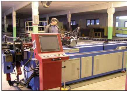
Spetsiaalselt ostenud torukoolutuspink võimaldab anda soovitud kuju kuni 6 meetri pikkusele metallitorule
