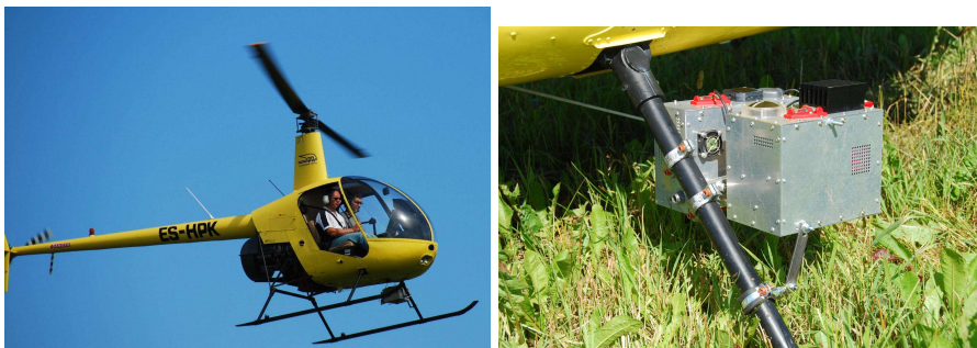
Figure 5.3: Helicopter measurements at Järvelja for the support of the CHRIS/Proba acquisition on 27th July 2011. Spectrometers UAVSpec3 and UAVSpec4SWNIR are fixed to the frame of Robinson 22. Metsade heledusspektrite mõõtmise kopterilt Robinson 22 spektromeetritega UAVSpec3 ja UAVSpec4SWNIR samaaegsel CHRIS/Proba mõõtmistega orbiidilt 27. juulil 2011.
