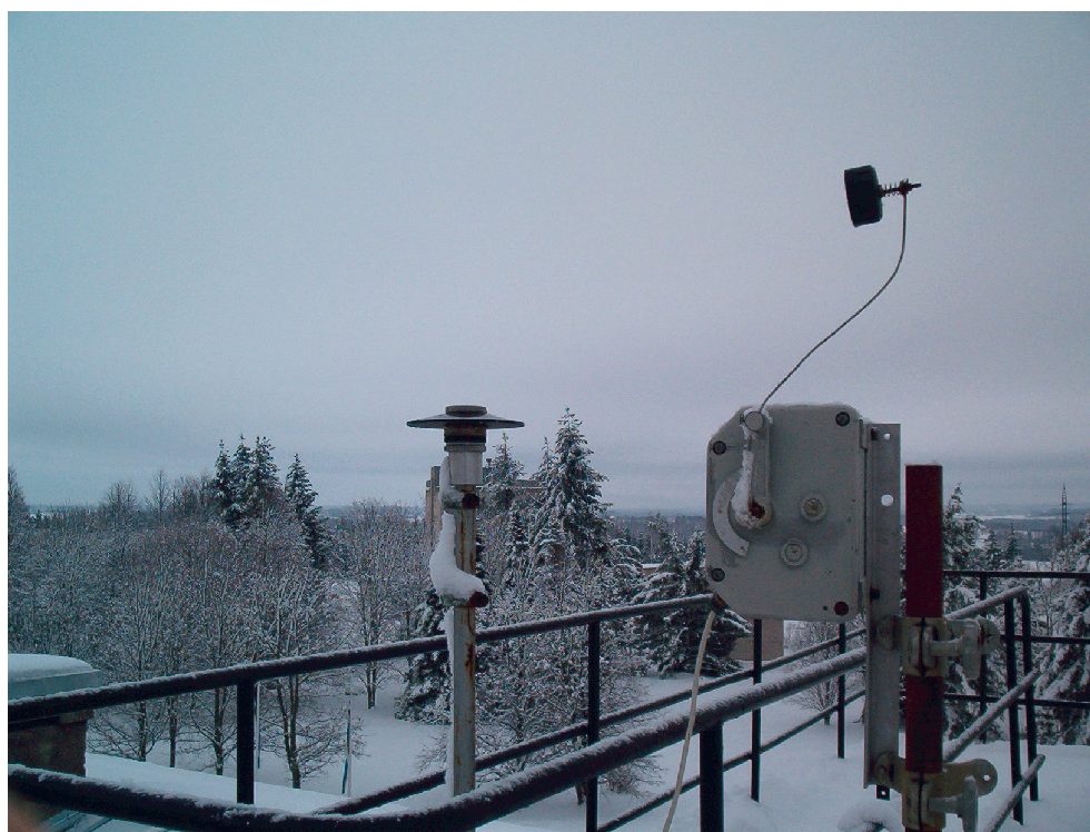
Figure 5.1: The solar UV spectrometer AvaSpec-256. Päikese UV-spektromeeter AvaSpec-256 igapäevases töös.
