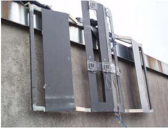
Joonis 10. Eksperimentaalne mõõtestend TTÜ V õppekorpusse seinal asimuudiga -10^\circ . Figure 10. Experimental stand of the measurements on the wall of 5-th building of TTU with the azimuth -10^\circ .
