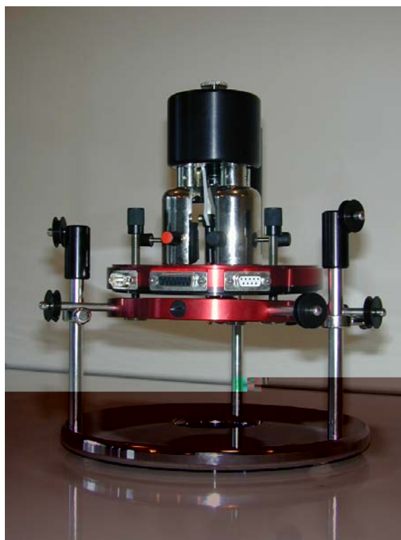
Joonis 3. TÜ FI-s loodud õppetstarbeline aatomjõumikroskoop – EduScope.
