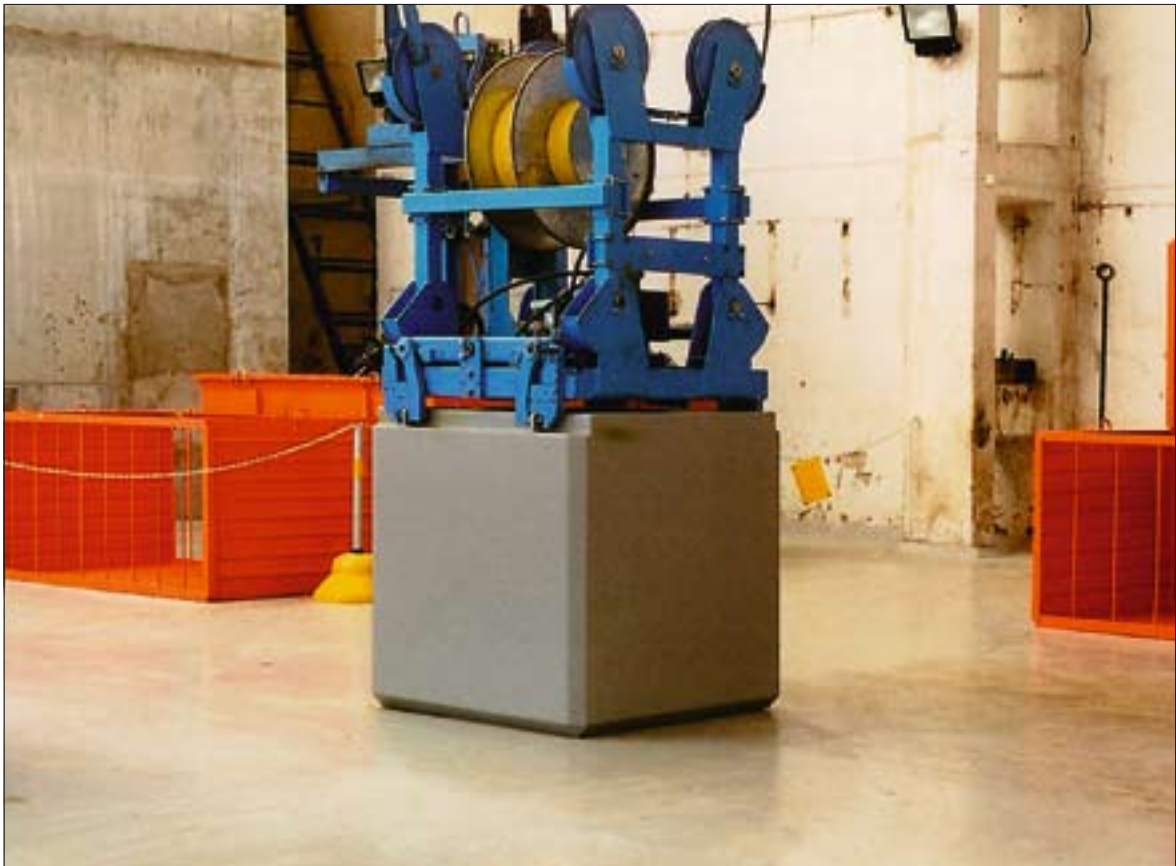
Jäätmekonteinerite vahehoidlasse toimetamiseks on kasutusel spetsiaalse haaratsiga varustatud sildkraana.
