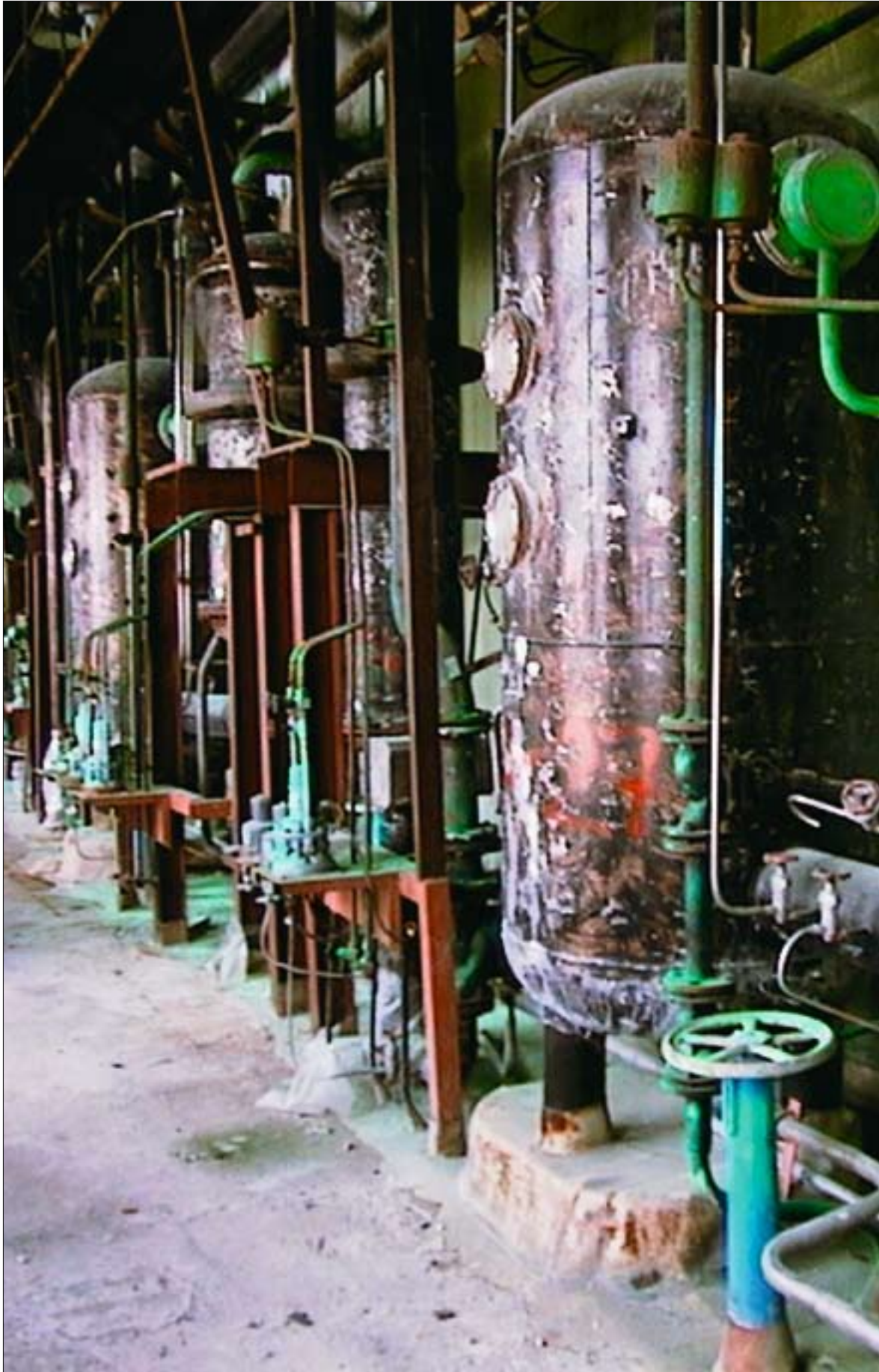
Radioaktiivsete vedeljäätmete töötlemiskompleksi aurutid, millelt on radioaktiivselt saastunud asbestikiht eemaldatud.
