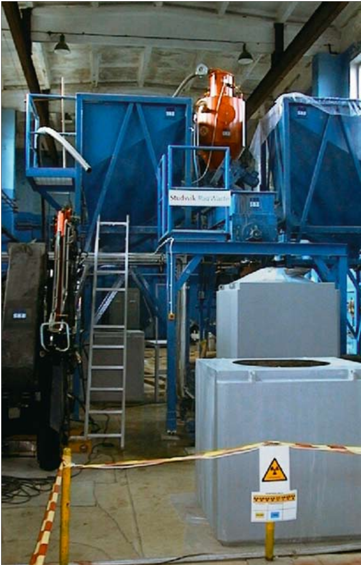
Tahkestamisseadmed on radioaktiivsete vedeljäätmete hoidlas paigaldatud ja tööks valmis.
