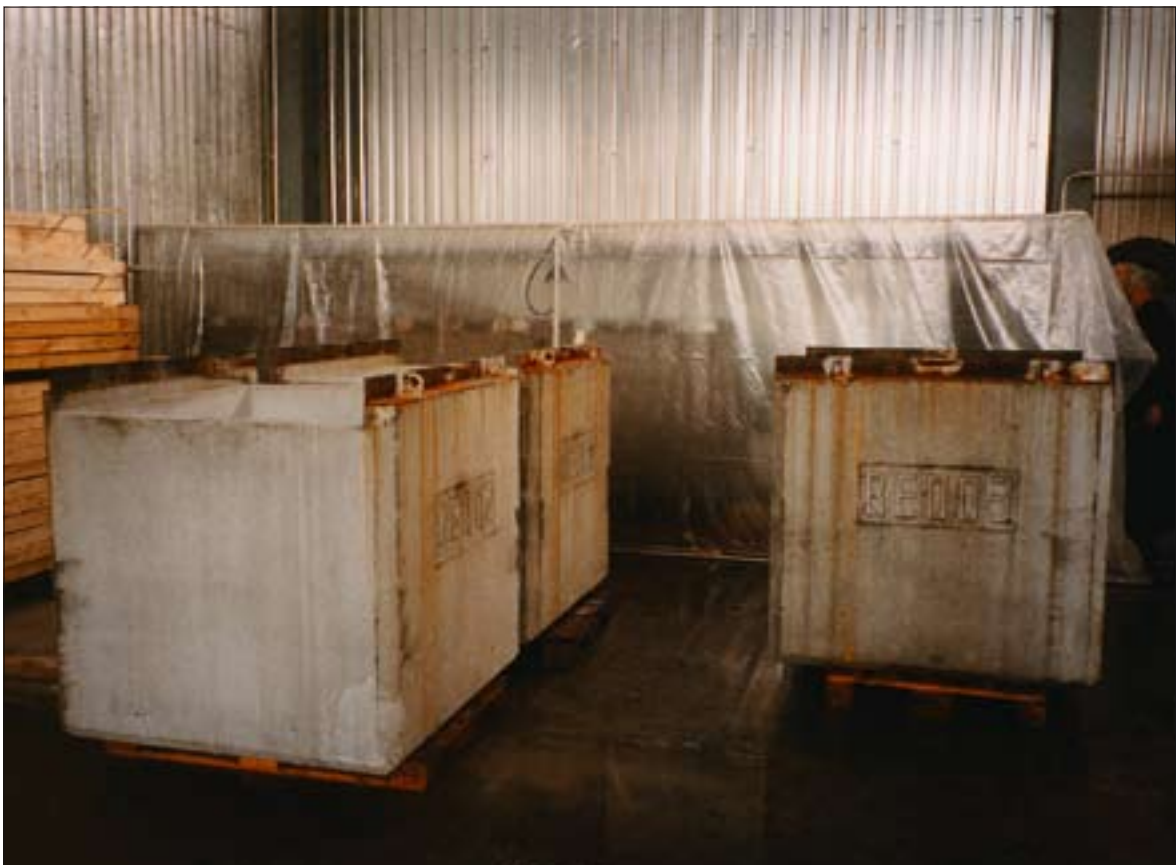
Radioaktiivsete jäätmete vahehoidlasse ladustatud jäätmed on paigutatud betoonist jäätmekonteineritesse.
