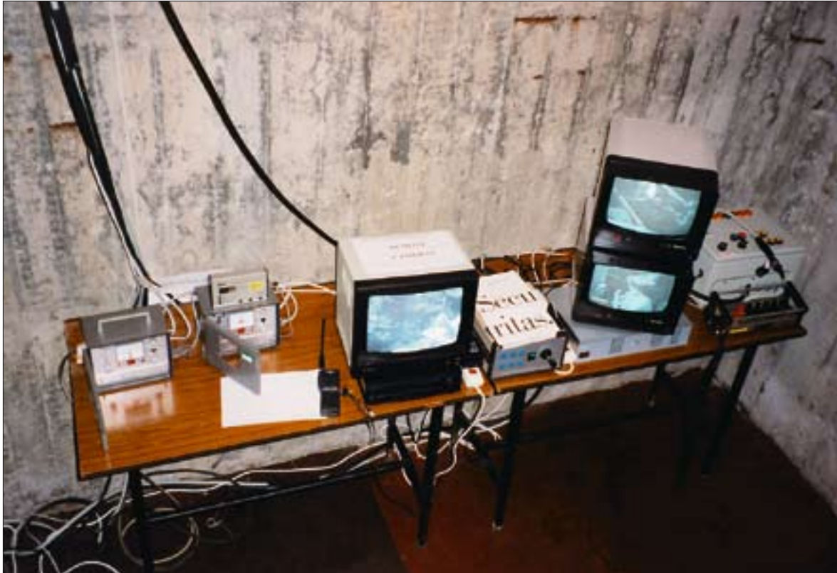
Vaid kolme tahkete radioaktiivsete jäätmete hoidla üheteistkümnest jäätmeseksioonist oli kasutatud jäätmete ladustamiseks. Üks tühjast seksioonidest kohandati operaatoriruumiks. Fotol kujutatud seadmete abil toimus robotkraana ja teiste kaugjuhitavate seadmete töö juhtimine.
