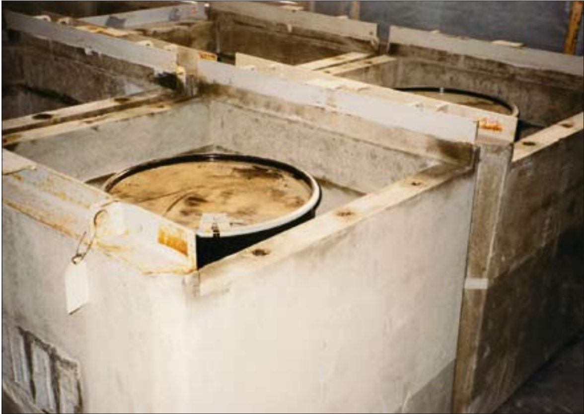
Hiljem paigutati jäätmevaadid betoonkonteineritesse. Järgnevate seksioonide tühjendamisel 200 l vaadid rohkem kasutust ei leidnud, jäätmed paigutati vahetult konteineritesse.
