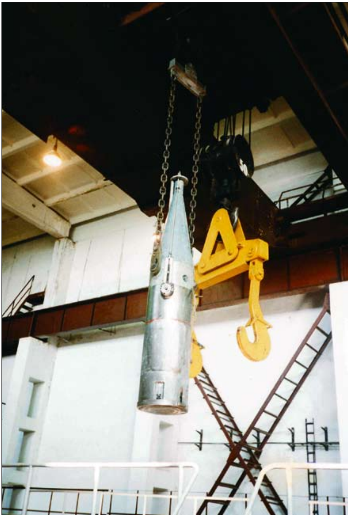
Tuumakütuse eemaldamine teise õppestendi reaktorist.
