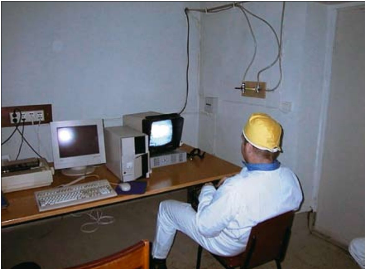
Robotkraana operaator juhtimas mahutiseadmete eemaldamist radioaktiivsete vedeljäätmete hoidlas.
