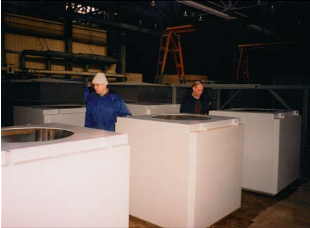
Radioaktiivsete vedeljäätmete hoidla mahutite setid tahkestati (betoneeriti) enne vahehoidlas ladustamist metallist jäätmekonteinerites.
