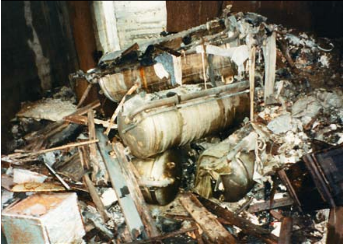
Radioaktiivsete tahkete jäätmete hulgas olid ka esimese õppestendi reaktori remonttööde käigus 1981. aastal väljavahetatud aurugeneraatorid.
