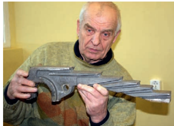
Ehituselolev katel väljast ja seest. Peeter Aasmaa (OÜ Wetorex) näitamas kolderesti lüli.
