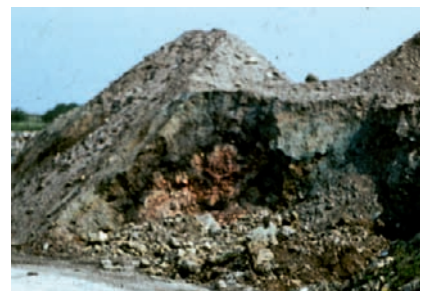
Joonis 3. Kaevamisega avatud kilda põlemiskolde Maardu karjääri lõunapuistangu nõlvas. The combustion centre of dictyonema oil shale opened after digging at the southern dump slope of Maardu quarry.
