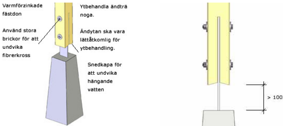
Puitposti alus, terasplaat on kinnitatud poltide ja suurte seibidega, vältimaks puidu kahjustumist.
