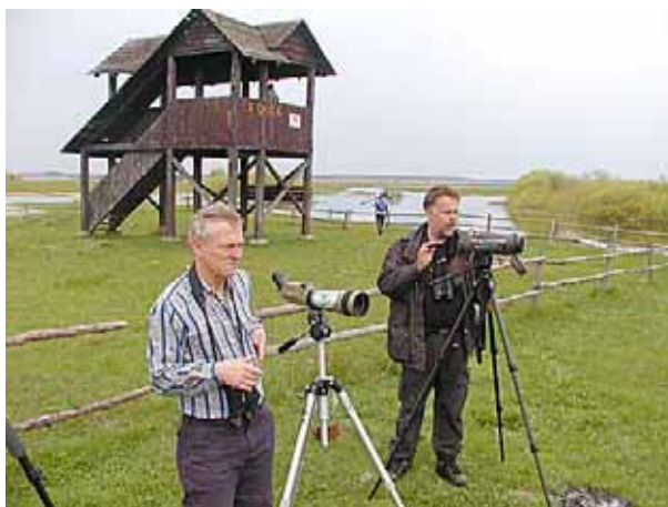
Taamal oleval tornil on laastukatus. Suure kalde tõttu voolab vesi kiiresti katusest ära.
