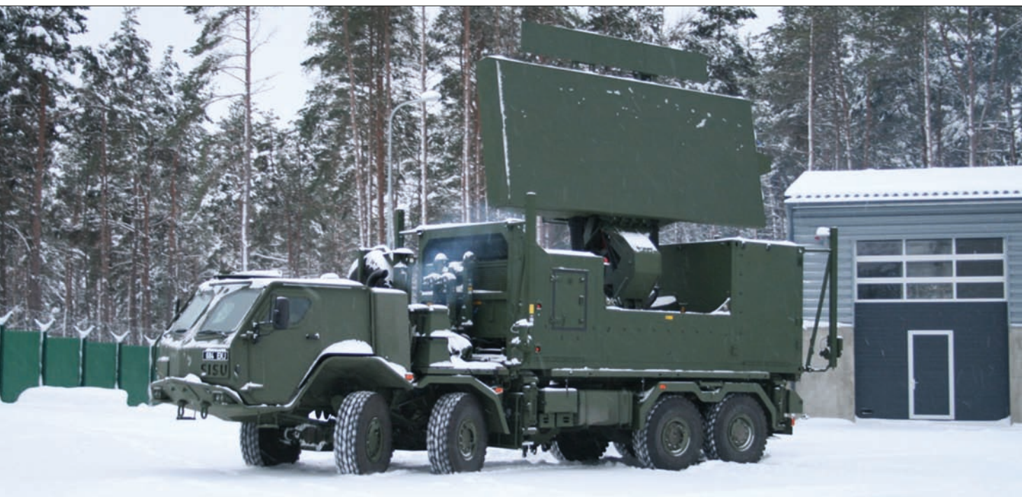
Mobiilne keskmaa radar Ground Master 403, autol SISU 8x8, Muhu radaripostil transportasendis, tõstetud radariantenniga.
