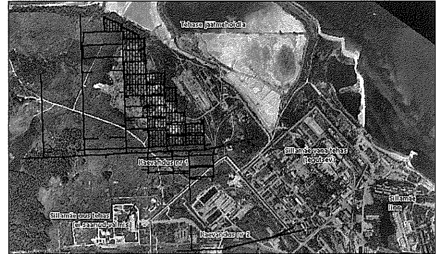
Joonis 4. Sillamäe uraanikaevanduse paiknemine. Jooned tähistavad kaevanduskäike, rastriga on kaetud kaevandatud ala.
