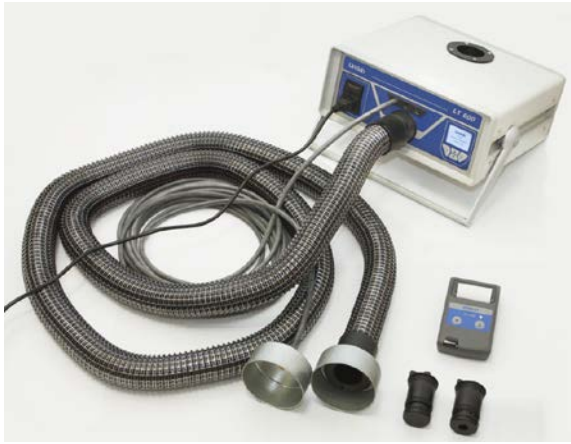
Joonis 3.16 Ventilatsioonitorustiku õhuleke mõõdetakse enne töö tellijale üleandmist kaetud tööde akteerimise ja kvaliteedokontrolli käigus (Mattson 2014, Retrotec).
