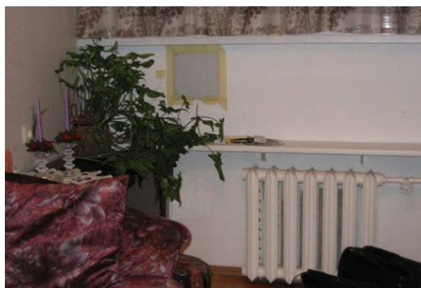
Joonis 2.31 Soojusvoo mõõtmise põhimõtteline skeem (vasakul) ja korterelamu välisseina soojustakistuse mõõtmine (paremal).
