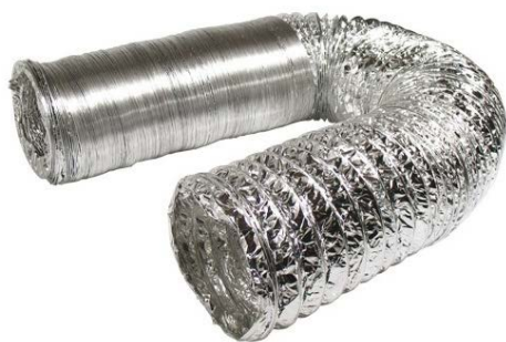
Joonis 3.12 Ventilatsioonitorustik koostatakse tsingitud plekist torudest või plasttorudest (ülal). Müügil on ka fooliumist painduvaid torusid, mida ei ole soovitatav kasutada, kuna need võivad puruneda ventilatsioonitorustiku mehaanilise puhastamise ajal.
