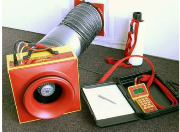
Joonis 3.16 Ventilatsioonitorustiku õhuleke mõõdetakse enne töö tellijale üleandmist kaetud tööde akteerimise ja kvaliteedokontrolli käigus (Mattson 2014, Retrotec).
