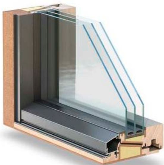
Joonis 2.36 Kvaliteetse soojustatud laia lengiga puit-alumiiniumakna ristlõige. Lai raam võimaldab paigaldada korralikku \geq 58 mm paksusega kolme klaasiga paketti (kolmest kaks kaasi on selektiivklaasid). Lenki ja raam on seina tasapinnas kitsad, minimeerides nii lengi ja raami kaudu toimuvat soojuslevi. Aknaraami sertifitseeritud soojusläbivus U_{f, all} = 0,72 \text{ W}/(\text{m}^2 \cdot \text{K}) , U_{f, küljed, üleval} = 0,64 \text{ W}/(\text{m}^2 \cdot \text{K}) ; f_{Rsi} \geq 0,76
